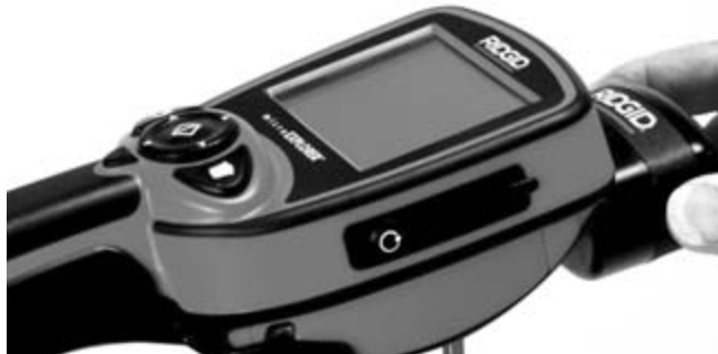
Slika 14 – Spajanje microExplorer monitora kamere
