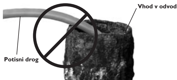
Slika 23 – Izogibajte se vleki pod ostrim kosom
