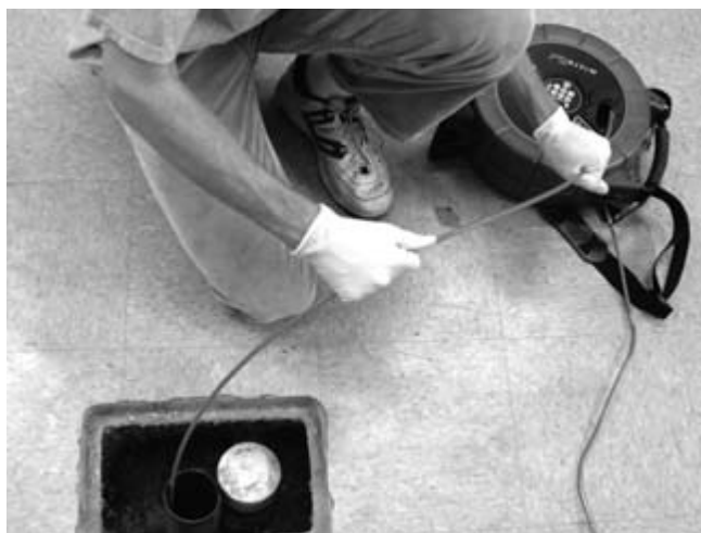
Slika 28 – Pravilna tehnika potiskanja kabla nazaj v boben
