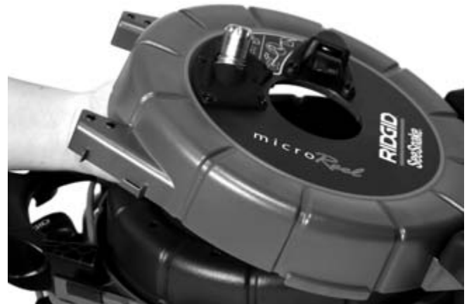
Figura 5 – Aprire con cautela il tamburo per instradare il cavo
