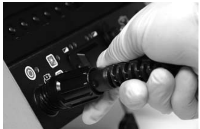
Figura 17 – Collegamento a una CCU SeeSnake
