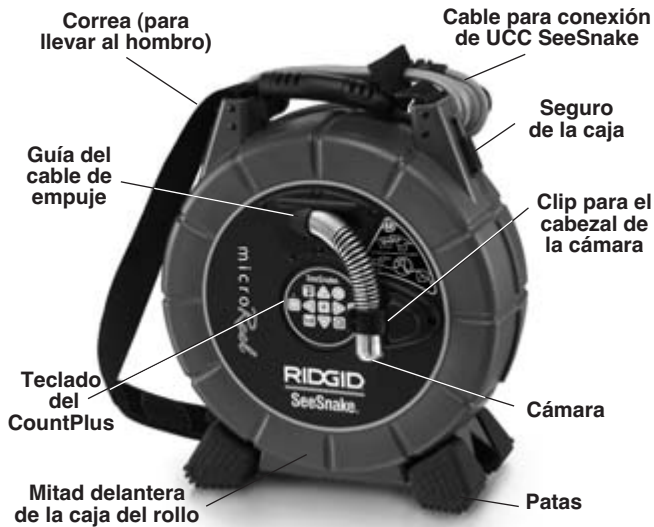
Figura 1 – Vista delantera (configuración SeeSnake)
