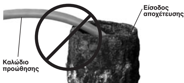
Εικόνα 23 – Μην τραβάτε υπό οξεία γωνία
