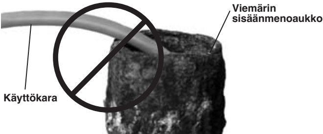
Kuva 23 – Vältä vetämistä terävissä kulmissa
