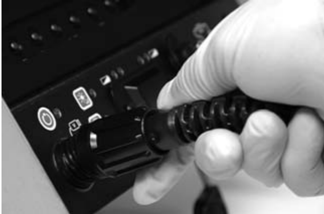
Slika 17 – Priključivanje na SeeSnake CCU
