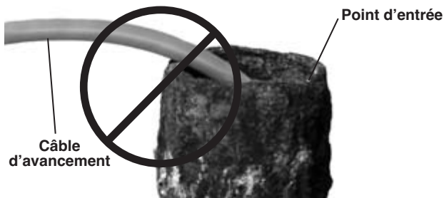
Figure 23 – Éviter d'appuyer contre le rebord
