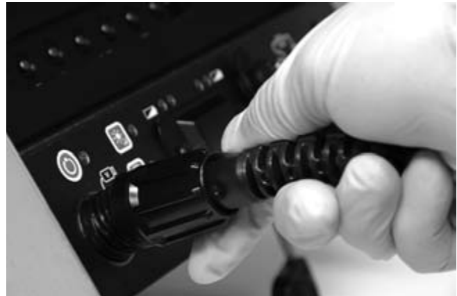
Εικόνα 17 – Σύνδεση σε μονάδα CCU SeeSnake
