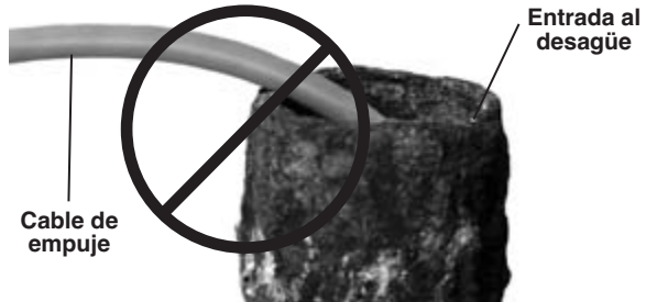
Figura 23 – Evite dañar el cable en bordes afilados
