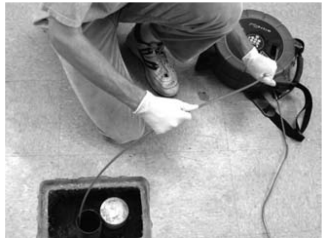
Slika 28 – Odgovarajuća tehnika za guranje kabla nazad u bubanj
