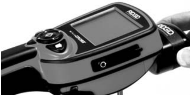
Figur 14 – Koble til microEXPLORER kameraskjerm
