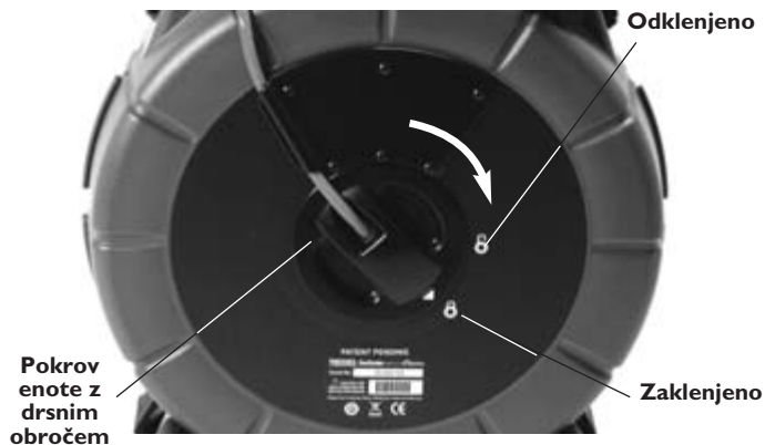
Slika 11 – Zaklepanje pokrova enote z drsnim obročem
