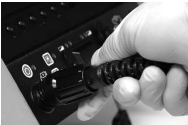
17. ábra – Csatlakoztatás a SeeSnake CCU egységéhez
