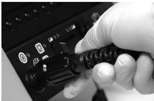
Obrázek 17 – Připojení k jednotce CCU SeeSnake
