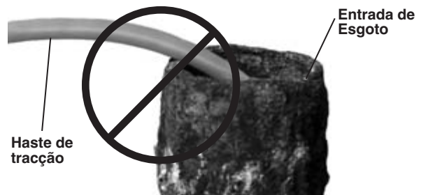
Figura 23 – Evite Puxar em Ângulos Apertados
