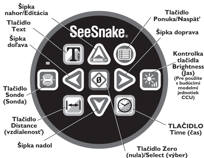
Obrázok 20 – Aktivácia voliteľnej klávesnice pre počítač CountPlus
