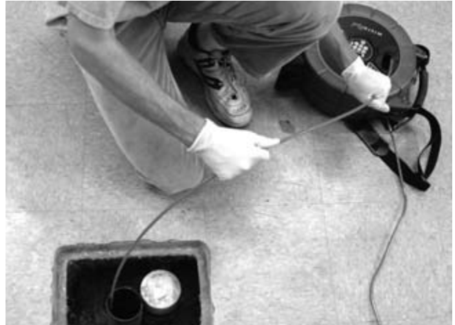
Figure 28 – Manière appropriée de rembobiner le câble d'avancement dans le tambour
