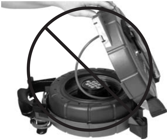
10. ábra – A kábelt ne engedje kontrollálatlanul letekeredni
