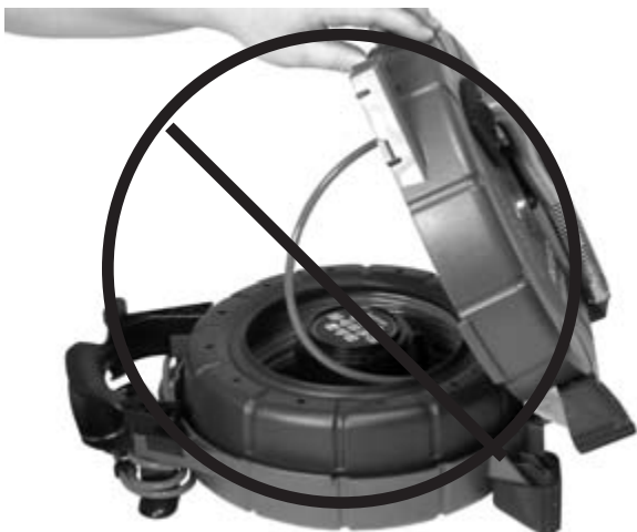
Figur 10 – Ikke la kabelen vikle seg av fritt
