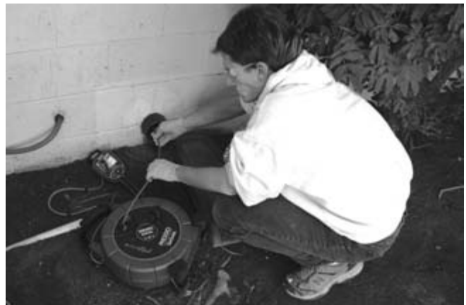
Slika 21 – Uporaba sistema microReel
