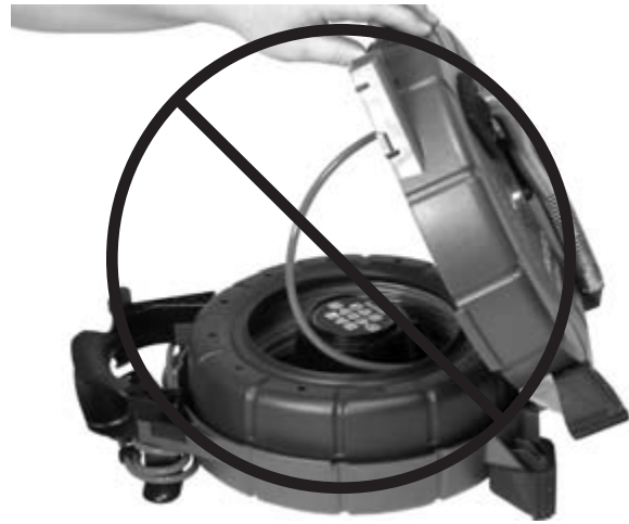
Figure 10 – Ne pas laisser le câble se débobiner
