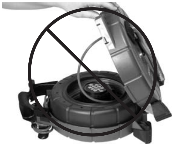
Figur 10 – Låt inte kabeln rullas av fritt
