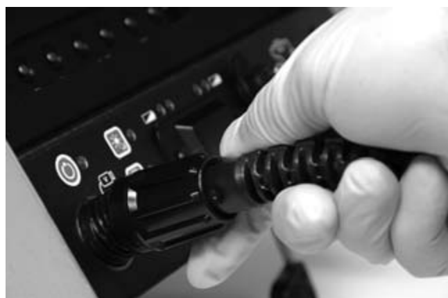
Figure 17 – Branchement sur CCU SeeSnake
