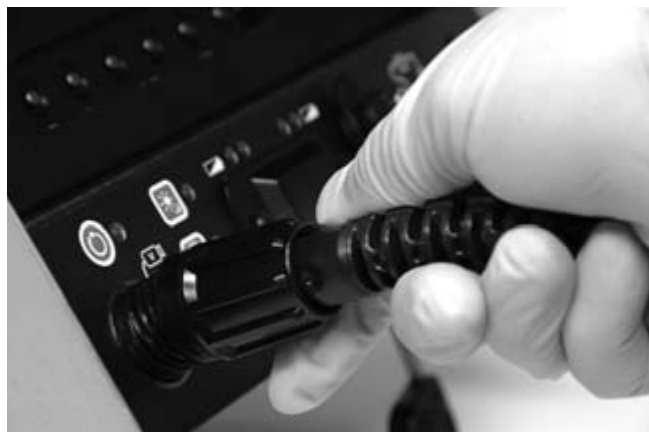
Figuur 17 – Aansluiten op een SeeSnake CCU
