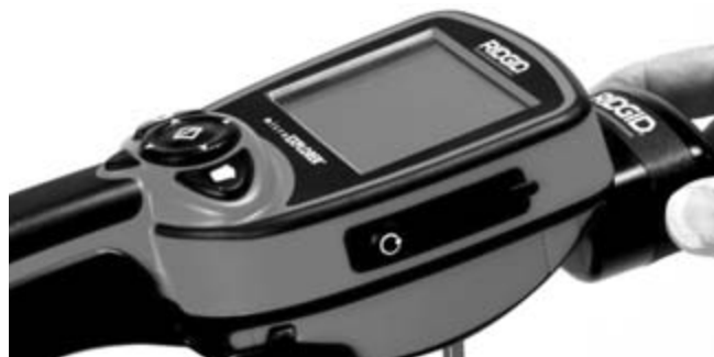
Figura 14 – Ligar o Monitor da Câmara microEXPLORER
