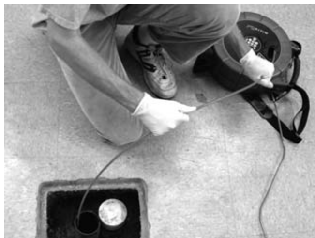
Obrázek 28 – Správný postup pro zatlačení kabelu zpět do bubnu
