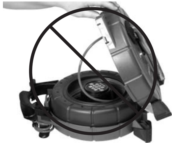
Abbildung 10 – Kabel nicht unkontrolliert herausfedern lassen
