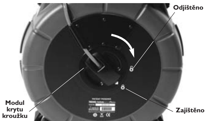
Obrázek 11 – Zajištění krytu kroužku
