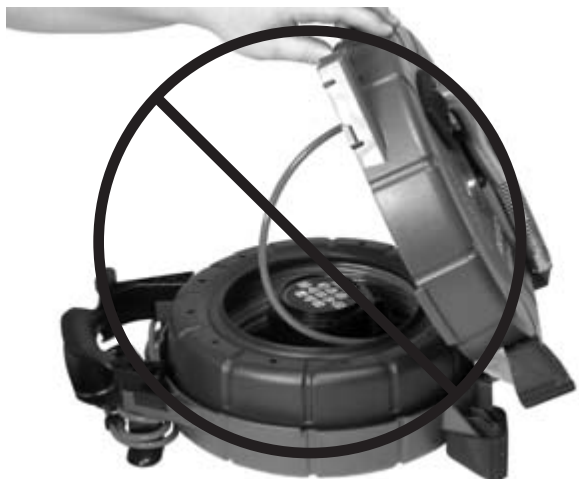
Obrázok 10 – Nedovoľte, aby sa kábel voľne odvíjal.
