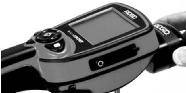
Obrázek 14 – Připojení kamerového monitoru microEXPLORER
