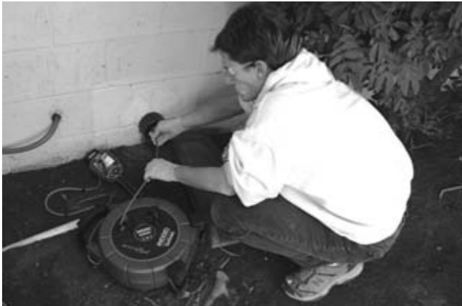
Figura 21 – Utilizar o microReel
