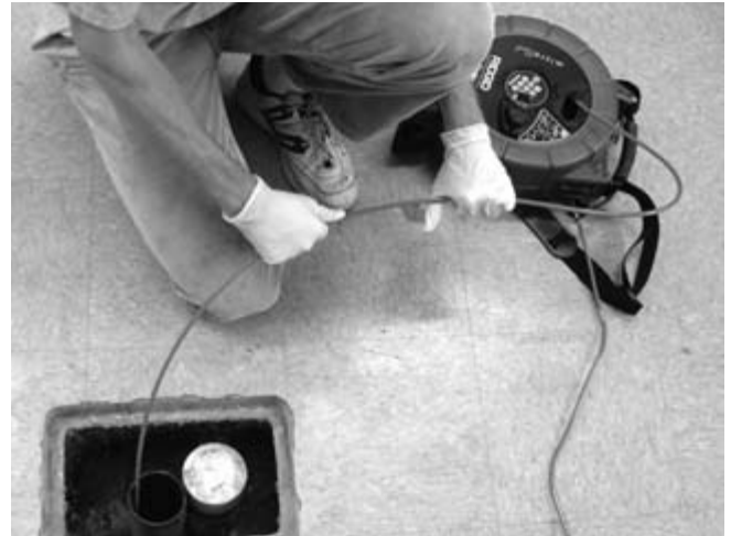
Figuur 29 – Wanneer u de kabel lussen laat vormen, kan hij knikken wanneer u ze in de haspel duwt
