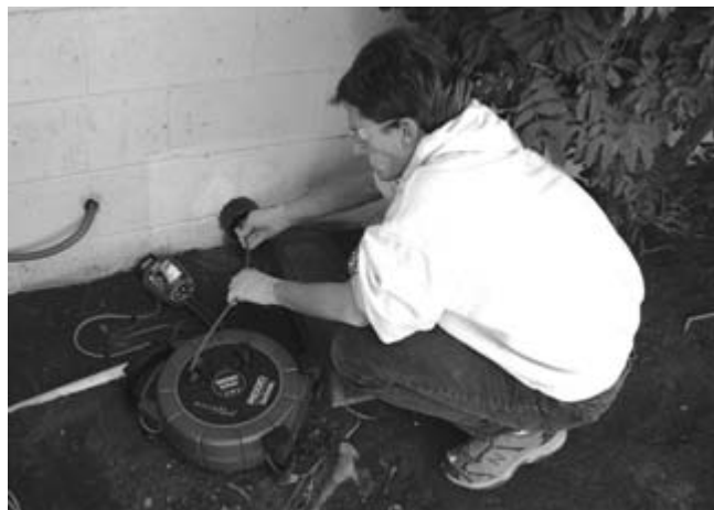
Figura 21 – Empleo del microReel
