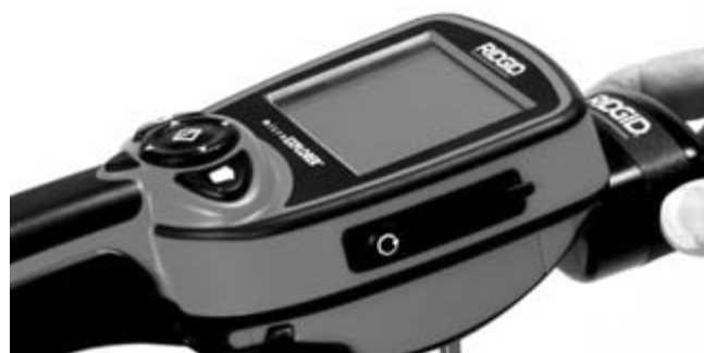
Figuur 14 – Aansluiten van de microEXPLORER-cameramonitor
