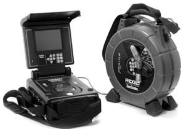
Figuur 18 – microReel aangesloten op SeeSnake® DVDPak CCU
