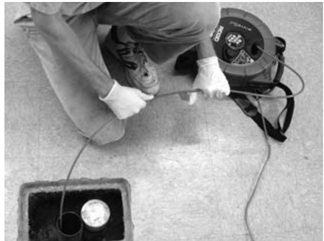
29. ábra – Ha a kábel felhurkolódhat, akkor törés következhet be a dobba visszahúzáskor
