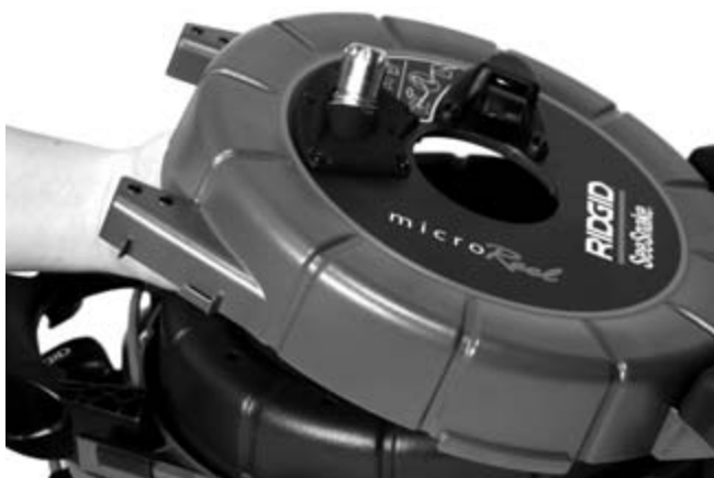
Slika 5 – Pažljivo otvorite bubanj da usmjerite kabel
