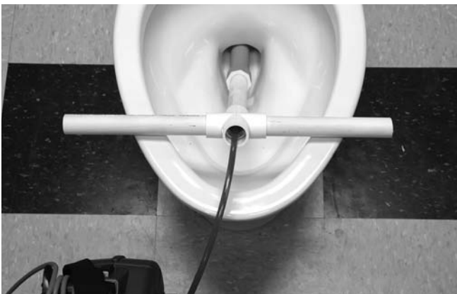
Figure 24 – Positionnement d'un tube de guidage en PVC
