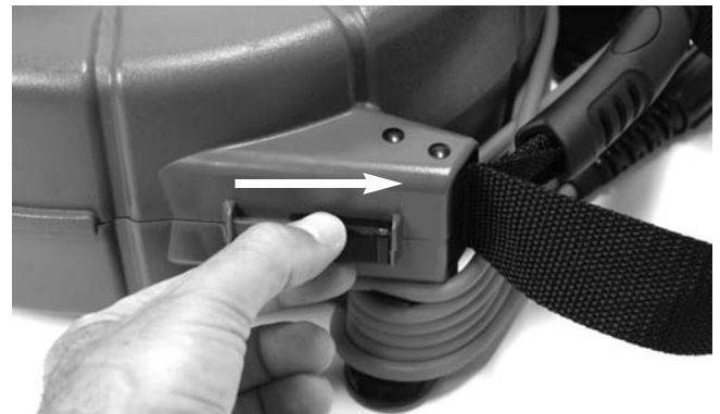
Obrázek 4 – Povolení pouzdra cívky microDrain
