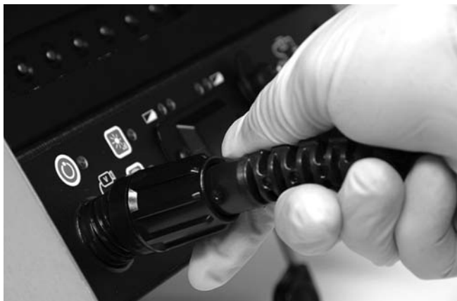
Εικόνα 13 – Σύνδεση σε μονάδα SeeSnake CCU
