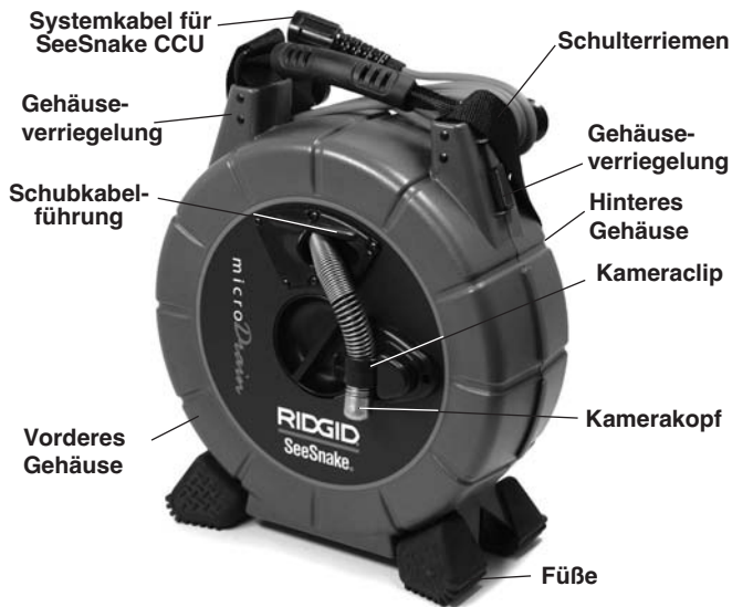
Abbildung 1 – Vorderansicht (SeeSnake Konfiguration)
