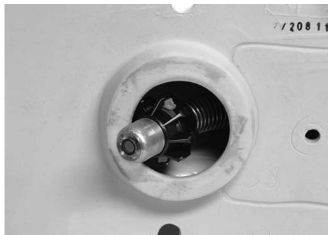
Εικόνα 21 – Κεφαλή κάμερας με σφαίρα οδηγό σε γωνία
