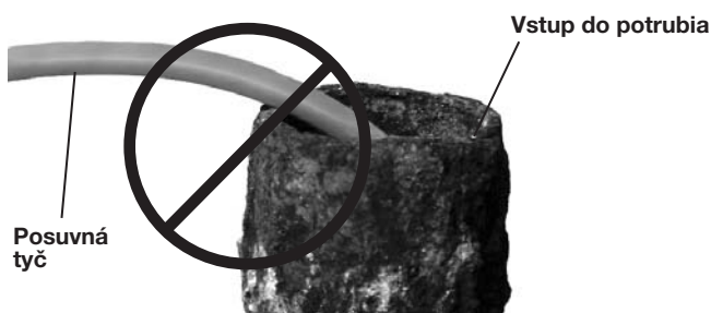
Obrázok 18 – Vyhýbajte sa ťahaniu za ostrými uhlami.
