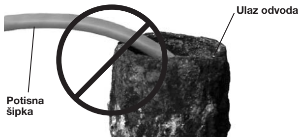
Slika 18 – Izbjegavajte povlačenje po oštrim rubovima
