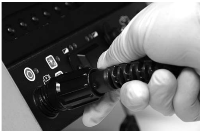
Slika 13 – Priklop na SeeSnake CCU
