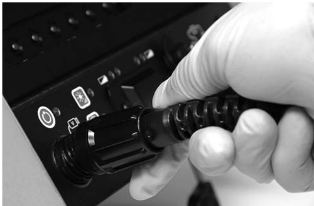
Figur 13 – Koble til en SeeSnake-kamerakontrollenhet
