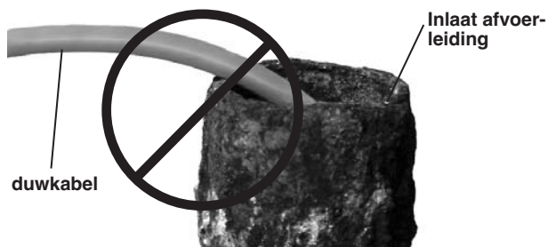
Figuur 18 – Niet in scherpe hoeken trekken
