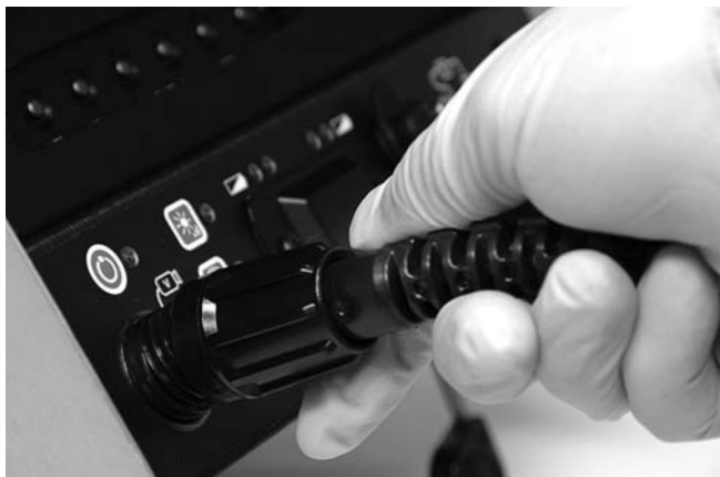
Figura 13 – Collegamento a un video CCU SeeSnake
