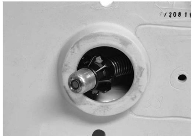
Figura 21 – Cap video cu ghidaj cu bilă în cotitură
