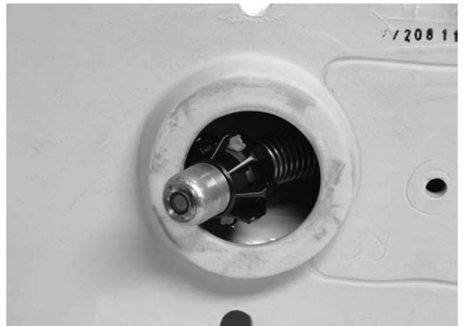
Kuva 21 – kamerapää ja kuulaohjain käännöskohdassa
