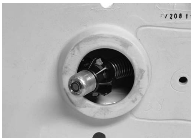
Figur 21 – Kamerahuvudet med kulstyrning i kröken
