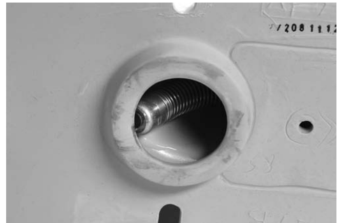
Figur 20 – Kamerahodet er blokkert i en sving.
