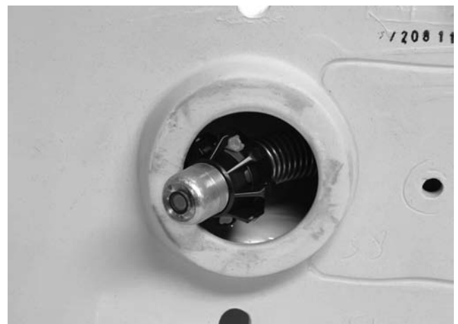
Figur 21 – Kamerahodet med styreball i en sving
