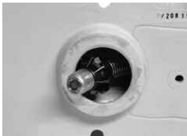
21. ábra: Kamerafej vezetógömbbel a fordulóban
