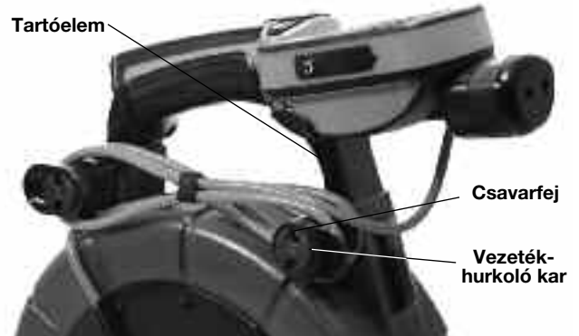
9. kép – tartóegység és vezetékhurkoló karok
