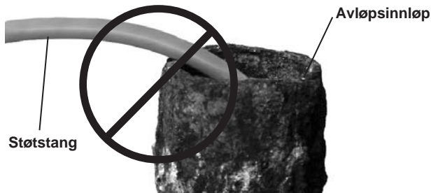
Figur 18 – Unngå å trekke den over skarpe kanter
