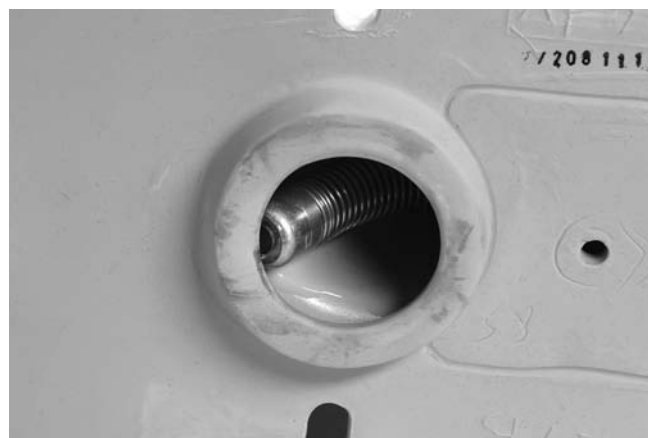
Slika 20 – Glava kamere blokirana pri zakretanju
