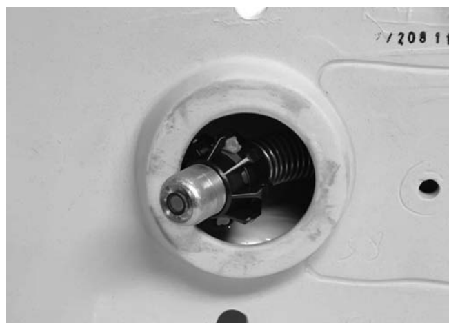
Obrázok 21 – Hlava kamery s guľovým navádzačom v zákrute
