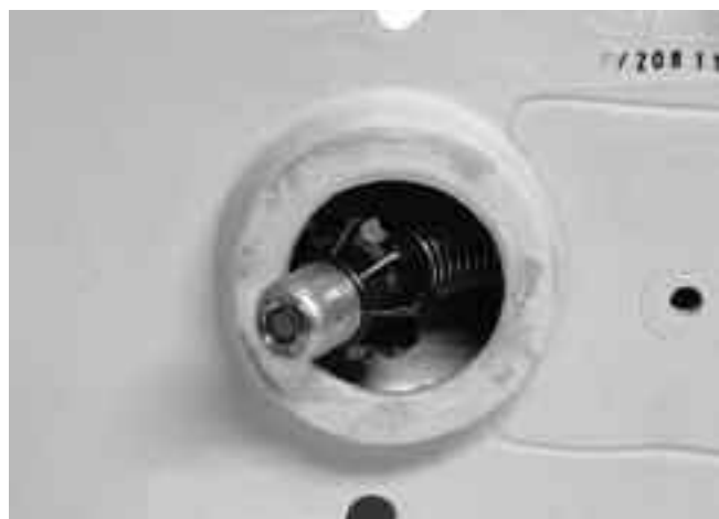
Ilustracja 21 – Głowica kamery z przewodnikiem kulowym na zakręcie
