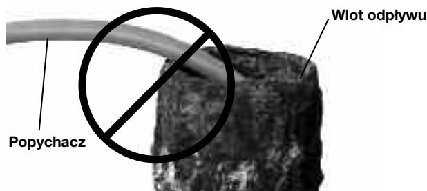
Ilustracja 18 – Unikać ciągnięcia pod ostrymi kątami
