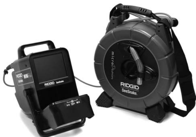
Slika 14 – Sistem microDrain priključen na CCU monitorja SesSnake® MINIPak
