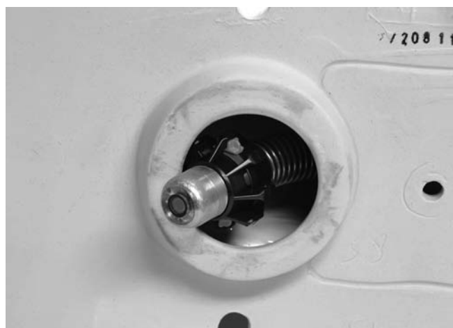
Figura 21 – Testina della videocamera con guida sferica nella curva
