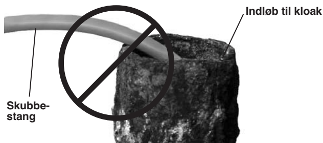
Figur 18 – Undgå at trække ved skarpe vinkler
