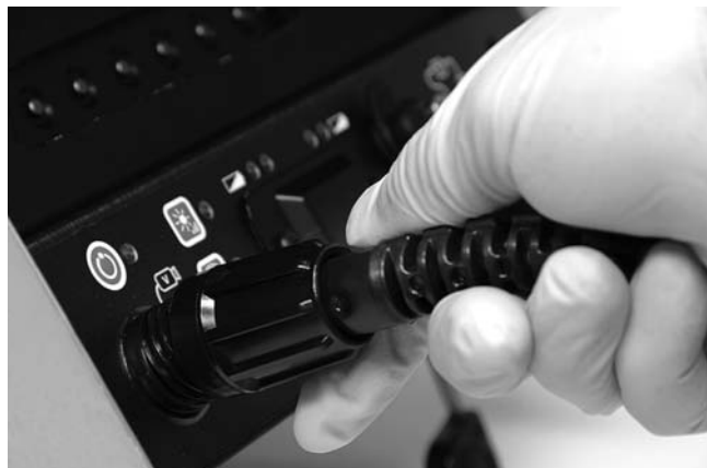
Figure 13 – Branchement sur CCU SeeSnake
