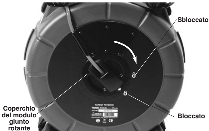
Figura 8 – Bloccare il coperchio del modulo del giunto rotante
