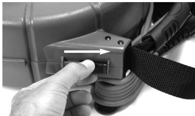
Εικόνα 4 – Απασφάλιση της Θήκης Μπομπίνας microDrain
