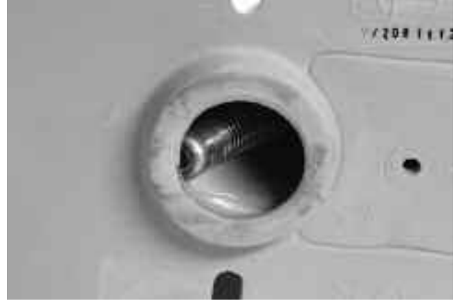
Şekil 20 – Dönüşte Engellenen Kamera Kafası
