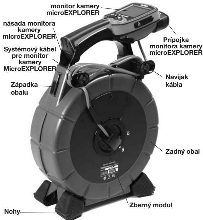
Obrázok 2 – Pohľad zozadu (nastavenie monitora kamery microEXPLORER)
