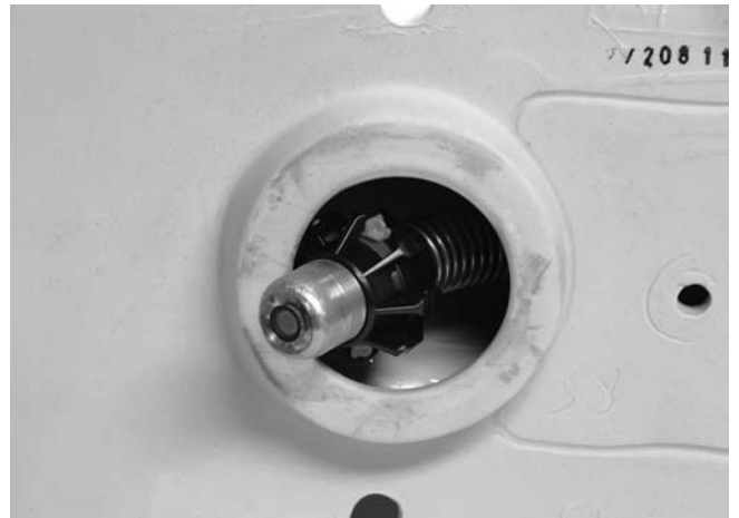
Figura 21 – La bola-guía la está ayudando a sortear la curva
