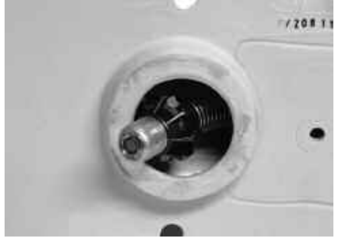
Figure 21 – Dönüşte Kamera Kafası ve Küre Kılavuz
