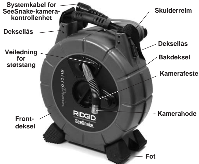
Figur 1 – Frontvisning (SeeSnake-konfigurasjon)
