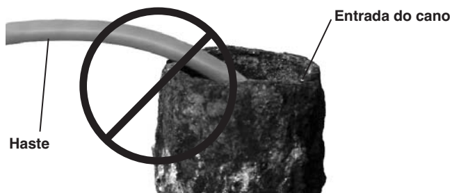
Figura 18 – Evite puxar em curvas apertadas
