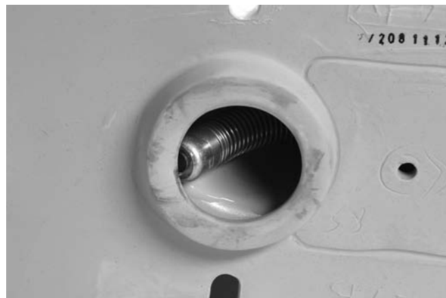
Рис. 20. Головка камеры заблокирована на повороте
