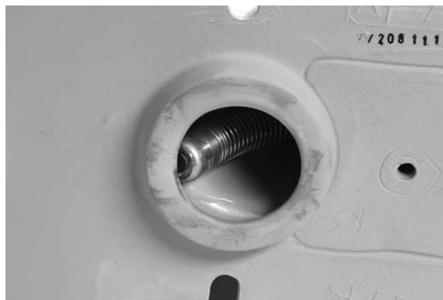
Figure 20 – Tête de caméra bloquée dans un coude
