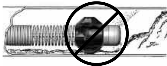
17. ábra: Találkozás az akadályal. Ne használja a kamerafejet arra, hogy az akadályt eltávolítsa.
