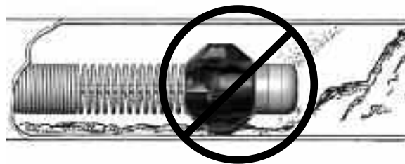
Ilustracja 17 – Napotykając przeszkodę – Nie używać głowicy kamery do usuwania przeszkód
