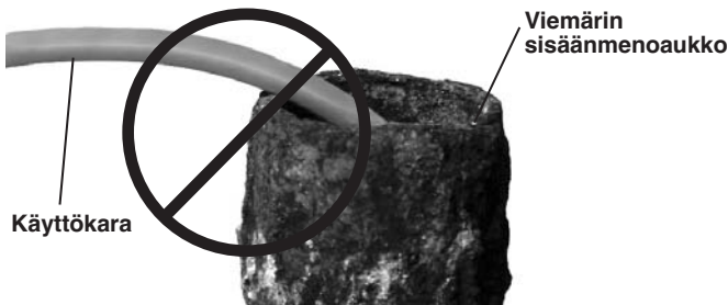
Kuva 18 – vältä vetämistä terävissä kulmissa
