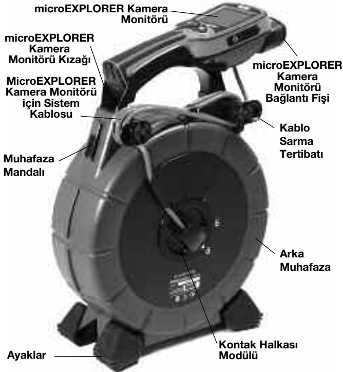
Şekil 2 - Arkadan Görünüm (microEXPLORER Kamera Monitörü Yapılandırması)
