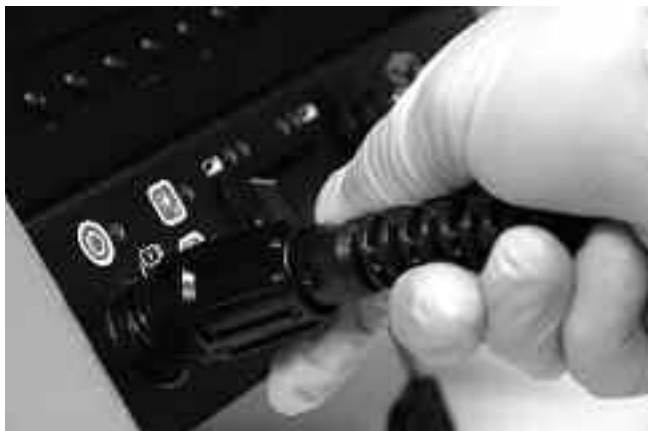
13. ábra: Csatlakoztatás a SeeSnake CCU egységéhez
