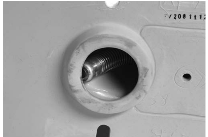
Kuva 20 – kamerapää tukkiutuneena käännöskohdassa
