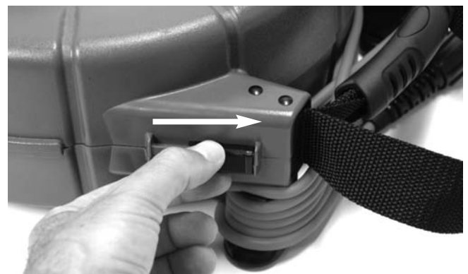
Figuur 4 – Behuizing van microDrain-haspel ontgrendelen
