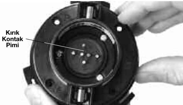
Şekil 7 - Kırık Kontak Pimi
