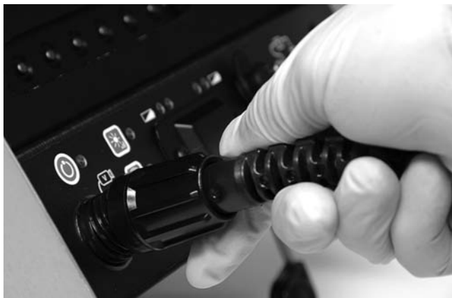
Figur 13 – Anslutning till en SeeSnake-kamerastyrenhet
