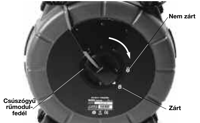
8. kép – A csúszógyűrűs modul fedelének rögzítése
