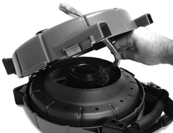
Obrázek 5 – Protážení hlavice kamery
