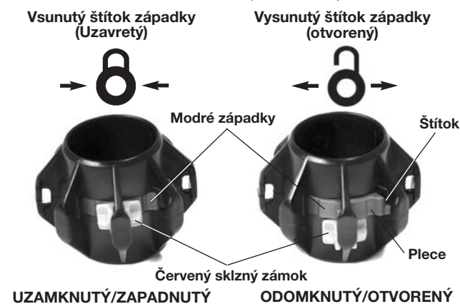
Obrázok 11 – Inštalácia guľového navádzača
