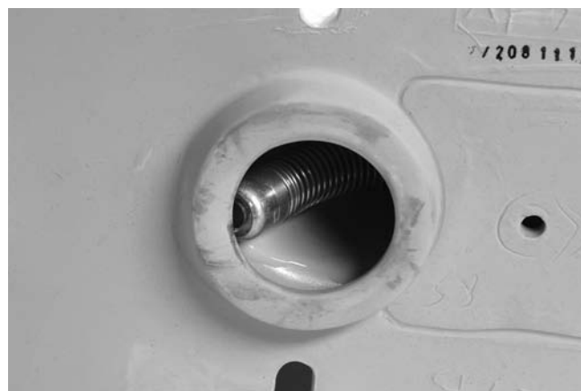
Slika 20 – Glava kamere blokirana na prevoju
