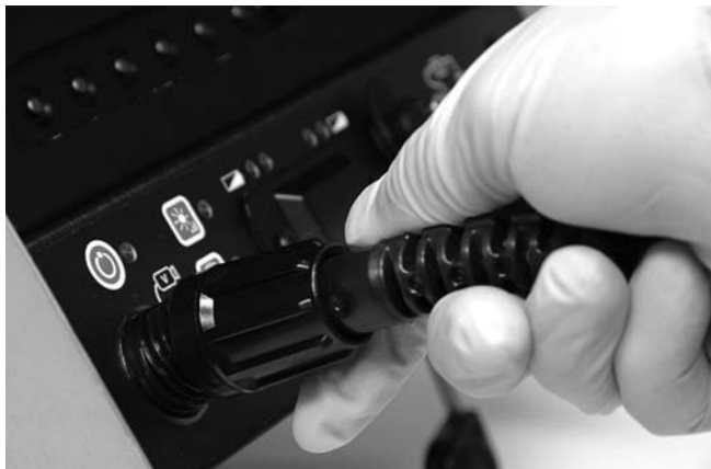
Figura 13 – Conectarea la o unitate de control a camerei SeeSnake.
