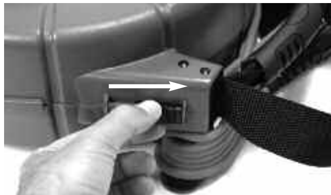
4. kép - a microDrain orsóház megbontása
