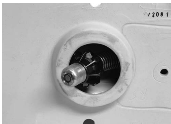
Slika 21 – Glava kamere s kuglastom vodilicom pri zakretanju
