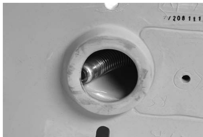
Figur 20 – Kamerahuvudet blockeras i en krök
