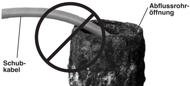
Abbildung 18 – Nicht im spitzen Winkel ziehen
