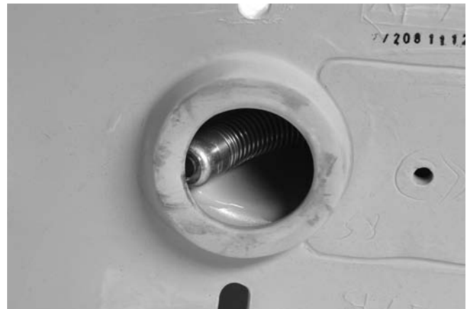
Εικόνα 20 – Κεφαλή κάμερας φρακαρισμένη σε γωνία
