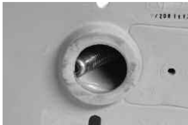
Ilustracja 20 – Głowica kamery zablokowana na zakręcie
