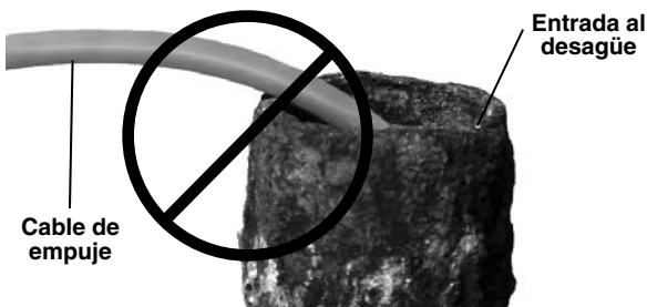
Figura 18 – Evite raspar el cable contra bordes afilados
