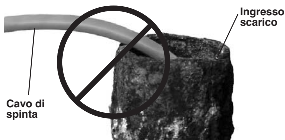
Figura 18 – Evitare di tirarlo contro angoli affilati
