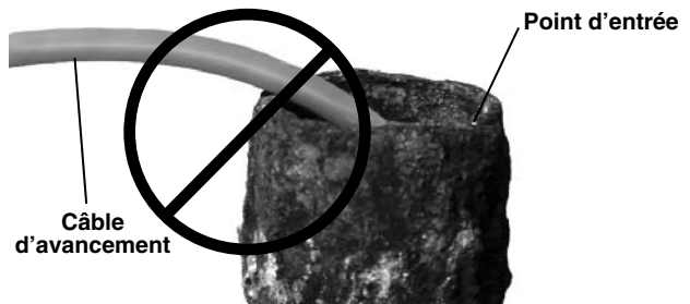
Figure 18 – Éviter d'appuyer contre le rebord
