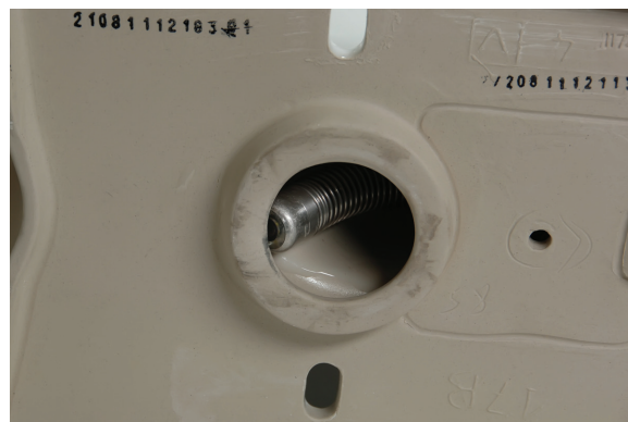
Рисунок 16 – Головка камеры застряла в изгибе
