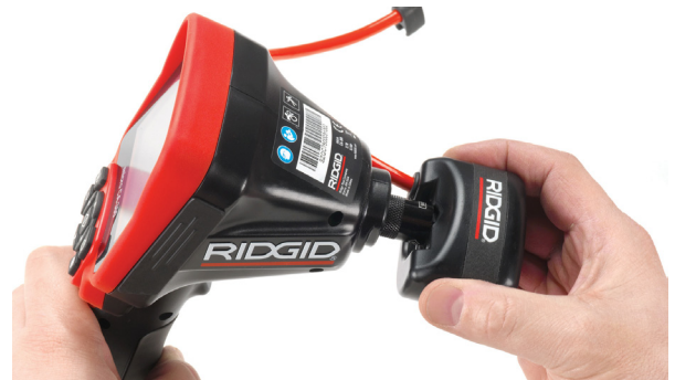
Рисунок 9 – Подключение камеры micro CA-300
