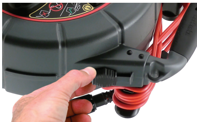
Рисунок 4 – Освобождение защелок корпуса устройства папоReel
