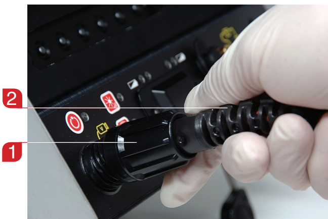
Рисунок 12 – Подключение к SeeSnake CCU
