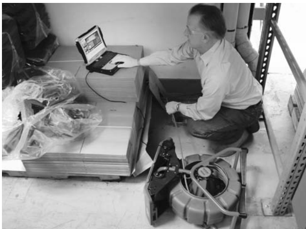
Figura 22 – El rollo SeeSnake acostado y la computadora puesta sobre una superficie estable
