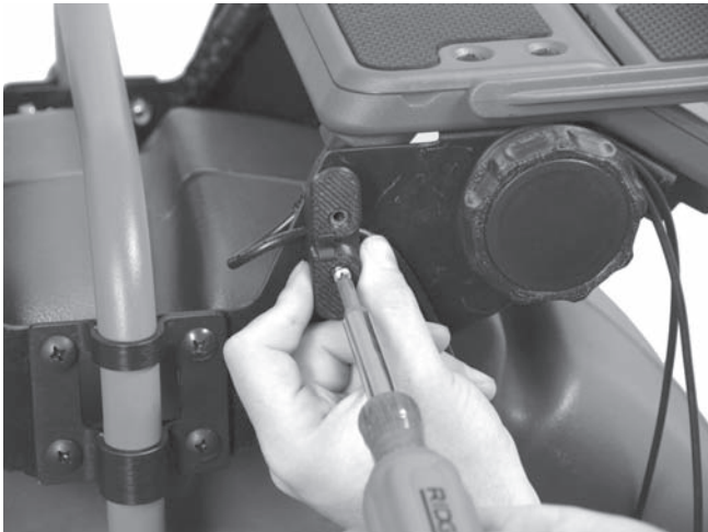
Kuva 16 – Kaapelivyhyhden asennus (huomaa USB-kaapeli kaapelivyhyhden alla)
