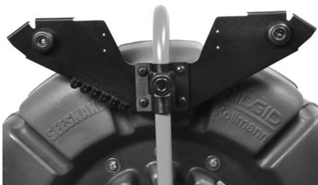
Figura 11 – Placa lateral más cercana ya instalada
