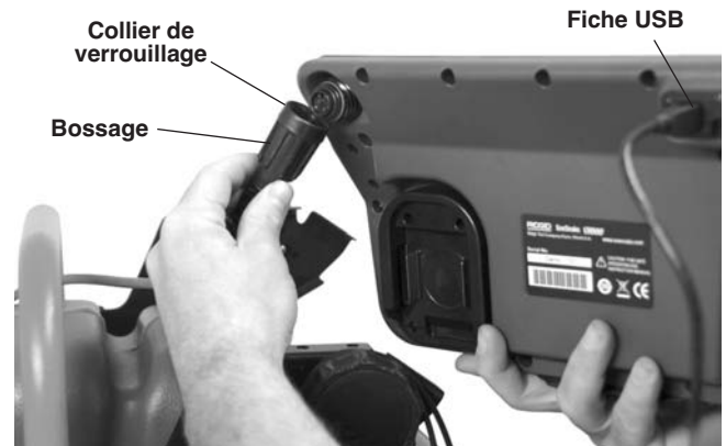
Figure 12 – Raccordement du câble de connexion SeeSnake
