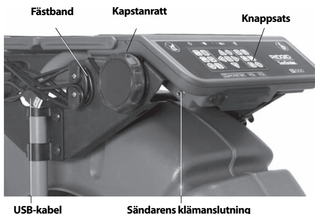
Figur 21 – Knappsats, kapstanratt och USB-kabel
