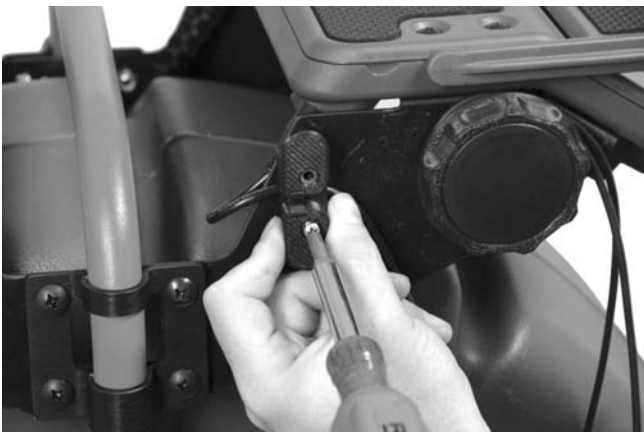
Figure 16 – Remontage de l'enrouleur de câble USB avec le câble USB passant derrière l'entretoise de l'enrouleur
