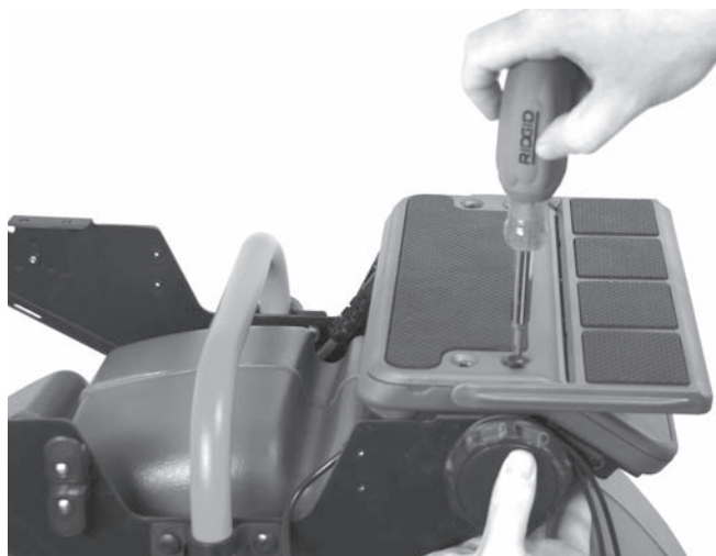
Figuur 13 – Monteren van het rechterplatform
