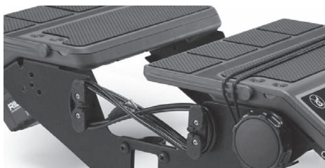
17. ábra – A kábeltekerceselő és az USB-kábel
