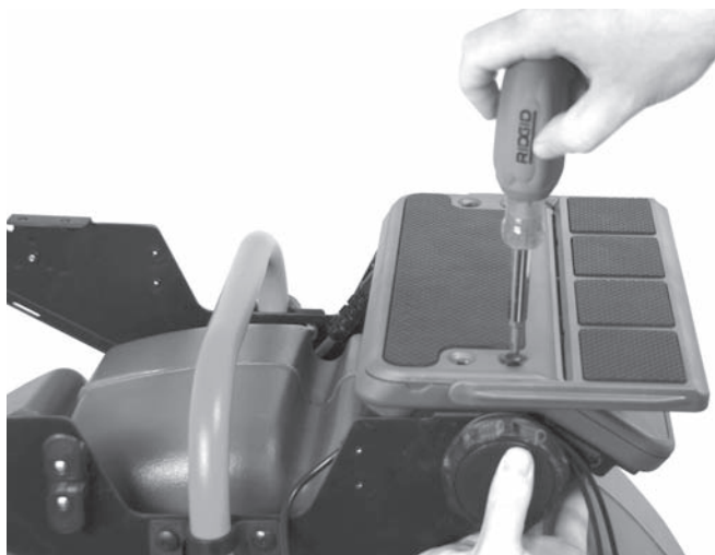
Figura 13 – Montar Plataforma Direita
