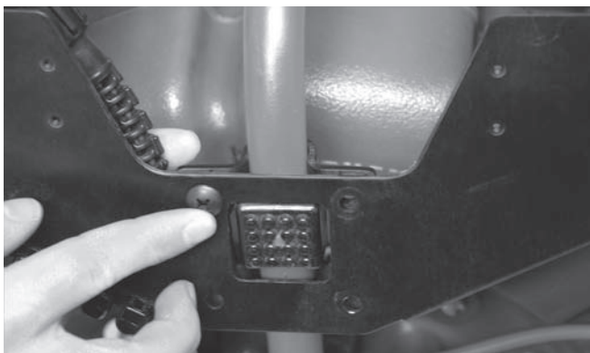
Figure 5 – Primo bullone di fissaggio
