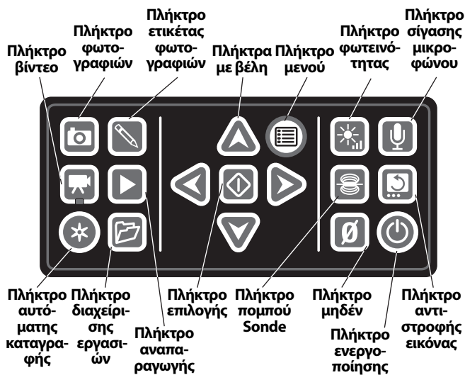
Εικόνα 3 – Πίνακας ελέγχου του LT1000
