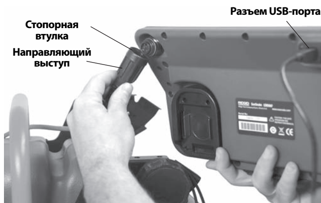
Рис. 12 – Крепление системного кабеля SeeSnake
