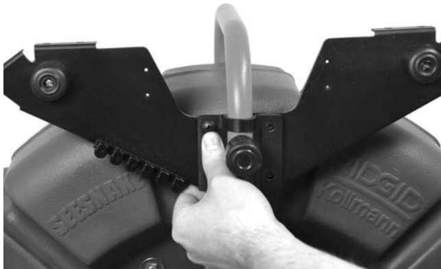
Figura 10 – Alineamiento de uno de los soportes de montaje con la placa lateral delantera
