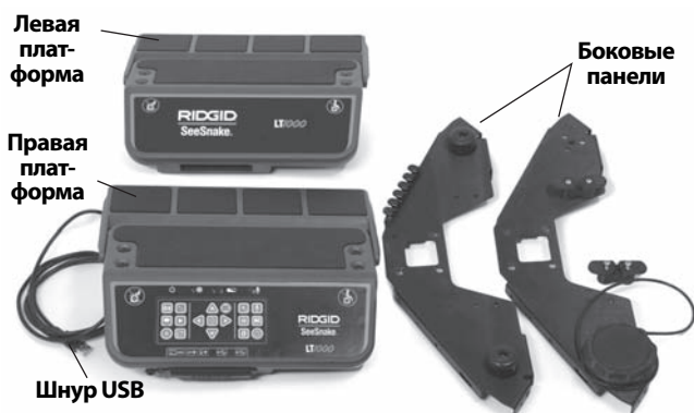
Рис. 9 – Детали прибора LT1000
