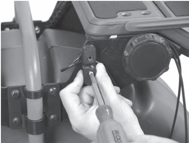
Abbildung 16 – Montieren der Kabelaufnahme (Beachten Sie das USB-Kabel unter der Kabelaufnahme)
