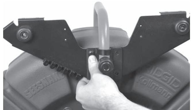
Abbildung 10 – Ausrichten der Halterung an der Seitenplatte
