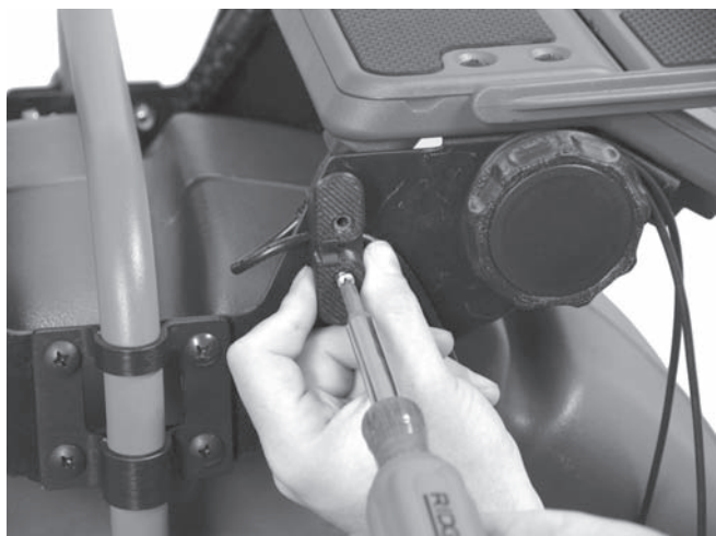
Figur 16 – Montera kabelbandet (Observera USB-kabeln som sitter undertill)
