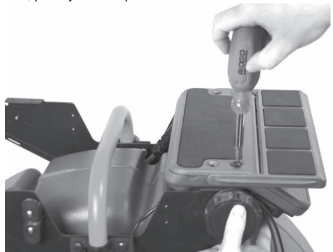
Obrázek 13 – Připevnění pravé nosné plochy
