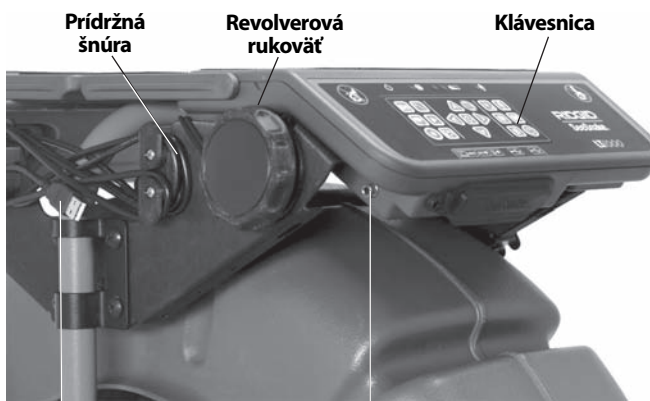
USB kábel Pridrzná šnúra Revolverová rukoväť Klávesnica Prípojná svorka vysielča Obrázok č. 21 – Klávesnica, revolverová rukoväť a obal USB kábla
