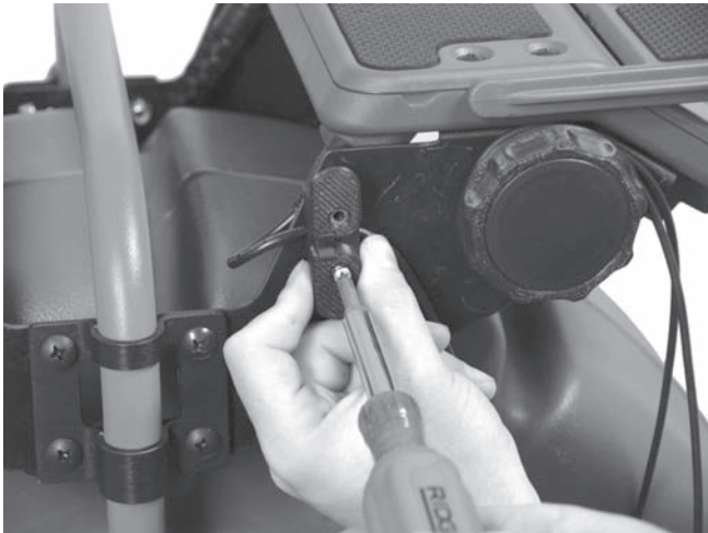
Figuur 16 – Monteren van de kabelopwikkelvoorziening (Noteer: USB-kabel geklemd onder kabelopwikkelvoorziening)
