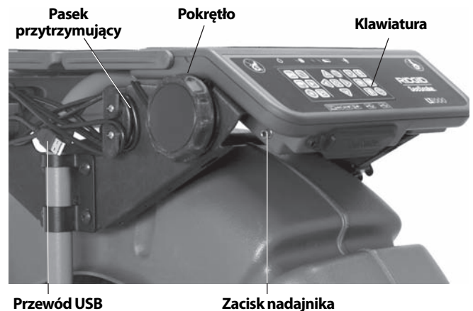
Rysunek 21 – Klawiatura, pokrętko i przewód USB
