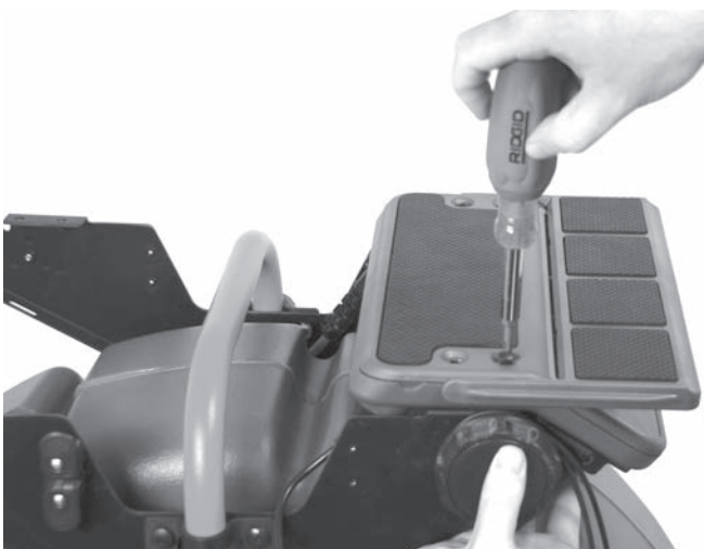
Abbildung 13 – Montieren der rechten Plattform
