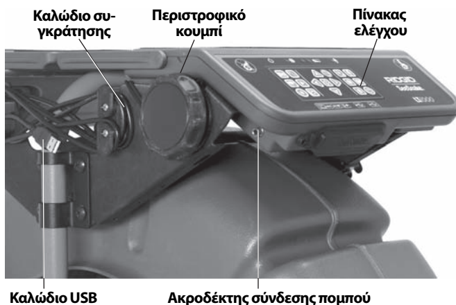
Εικόνα 21 – Πίνακας ελέγχου, περιστροφικό κουμπί και καλώδιο USB
