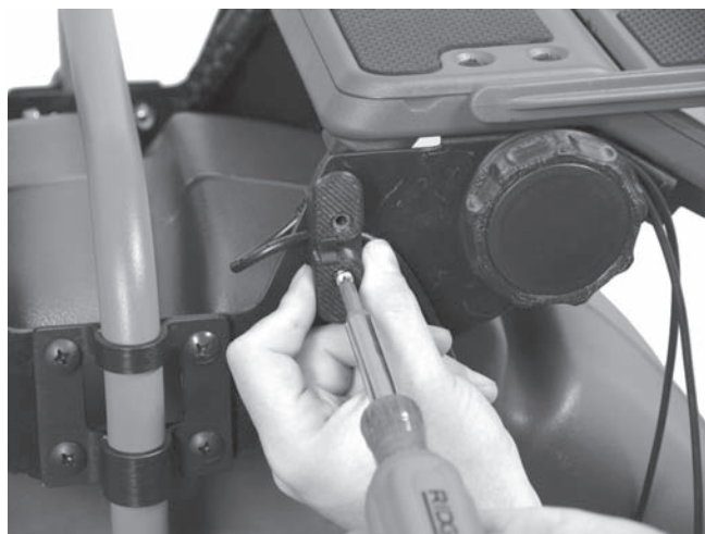
Figura 16 – Montar o suporte do cabo (Tenha em atenção para prender o cabo USB por baixo do suporte do cabo)
