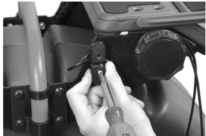
Figura 16 – Montaje del portacable (debajo de él queda apresado el cable USB)
