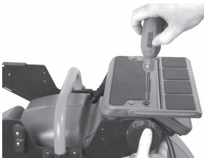
Figura 13 – Montaggio della piattaforma destra
