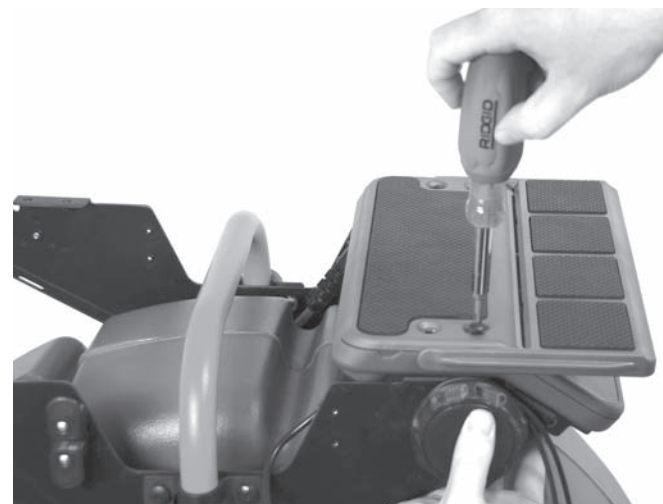
Slika 13 – Montiranje desne strane platforme
