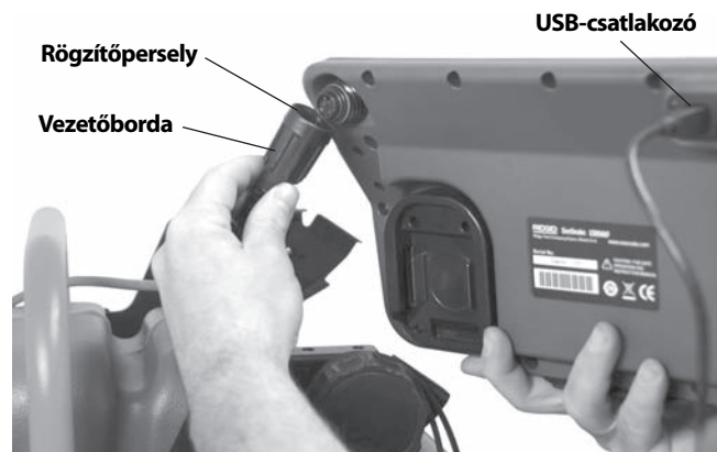
12. ábra – A SeeSnake rendszerkábel rögzítése
