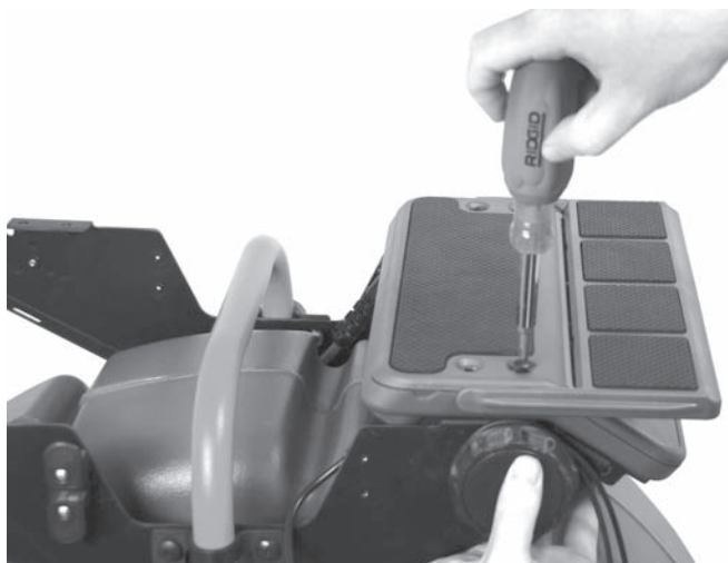
Rysunek 13 – Montaż prawej platformy
