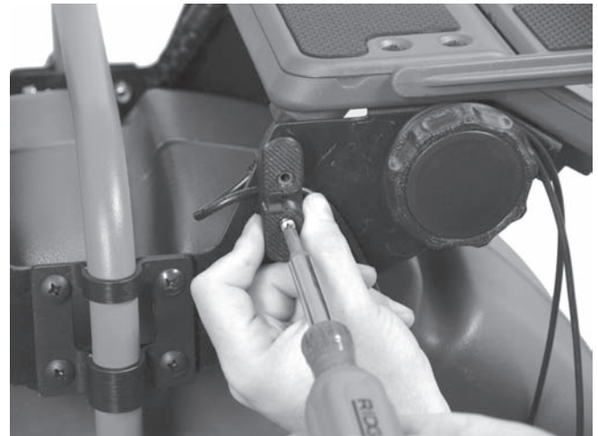
Рис. 16 – Установка крепления бухты кабеля (Обратите внимание, что кабель USB находится под креплением бухты кабеля)
