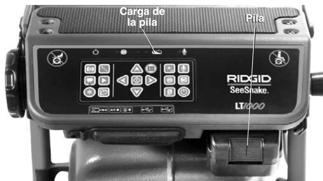
Figura 25 – Conexiones del LT1000
