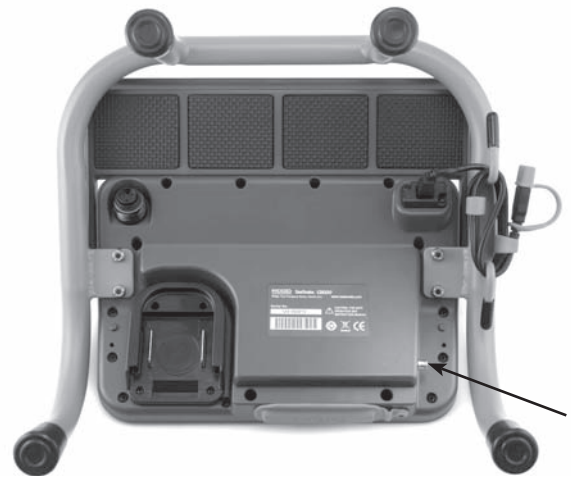
Rysunek 27 – Zacisk nadajnika LT1000
