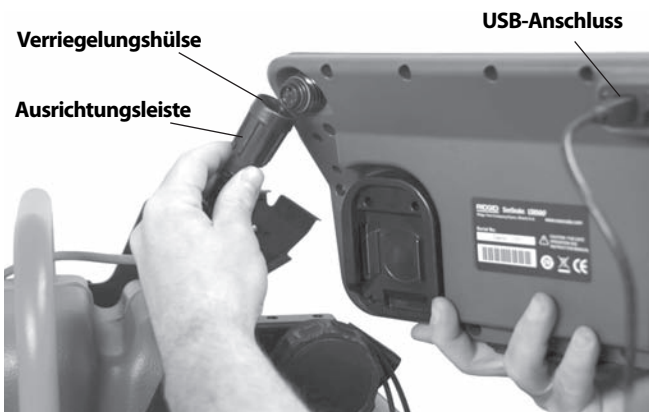
Abbildung 12 – Anbringen des SeeSnake Systemkabels
