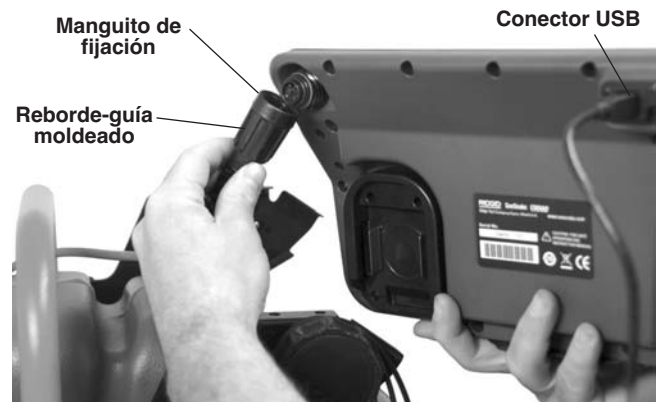
Figura 12 – Conexión del cable del sistema SeeSnake
