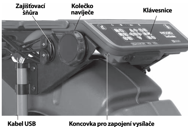
Obrázek 21 – Klávesnice, kolečko navíječe a USB kabel
