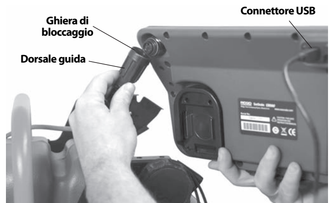
Figure 12 – Collegamento del cavo di interconnessione SeeSnake
