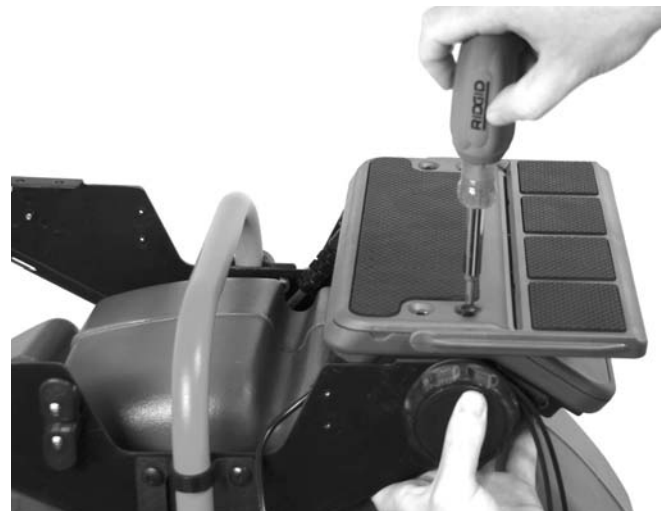
Figura 13 – Montaje de la plataforma derecha
