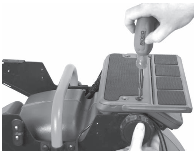
Obrázok č. 13 – Montáž pravej plošiny
