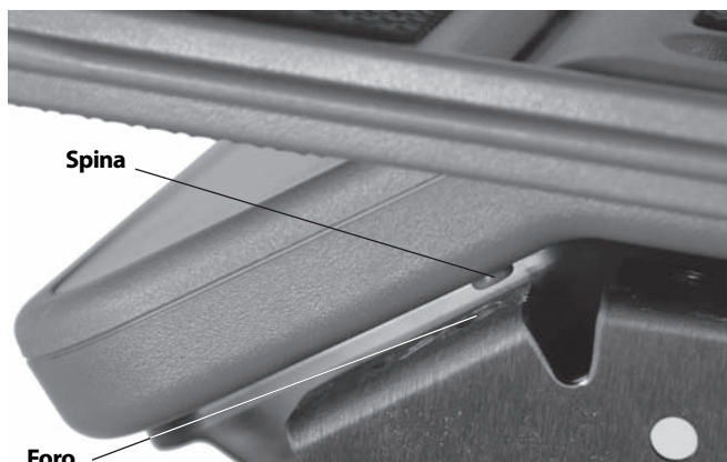
Figura 14 – Spina e foro di allineamento
