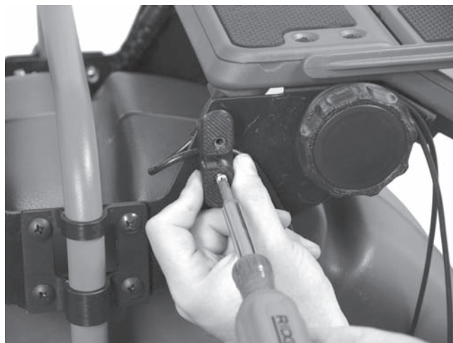
Obrázek 16 – Připevnění úchytní navinutí kabelu (Dbejte na zachycení USB kabelu pod úchytní navinutí kabelu)
