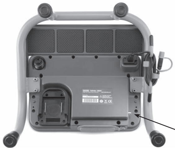
Figura 27 – Borna prinsă pe emițător a LT1000
