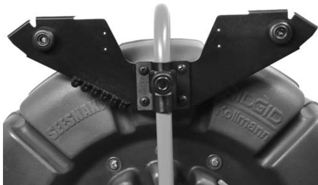
Figure 11 – Flasque côté intérieur montée
