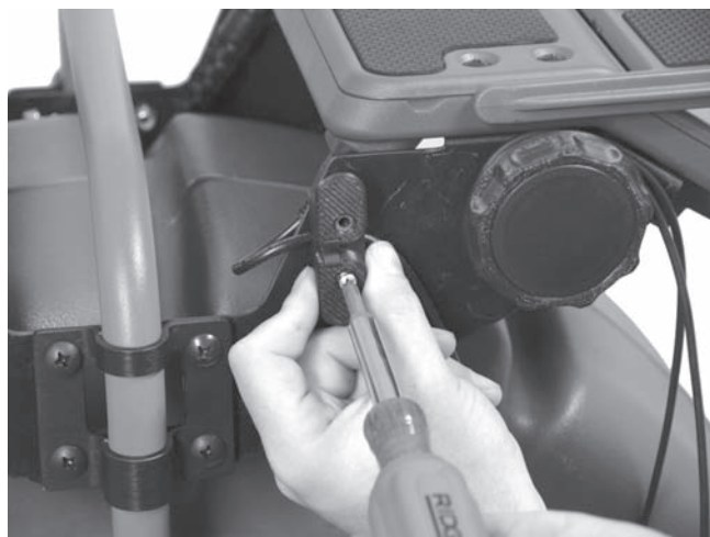
Figura 16 – Montarea înfășurătorului cordonului (Observați cablul USB prins de înfășurător)
