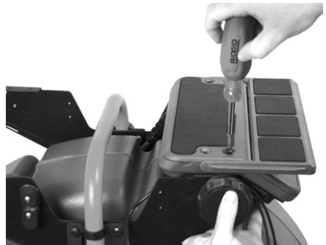
Figure 13 – Montage de la plate-forme droite
