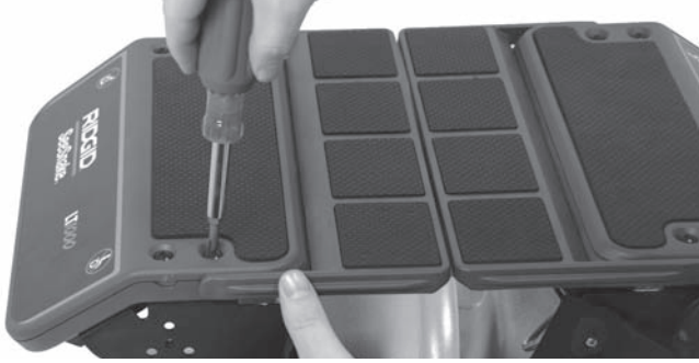
Şekil 15 - Sol Platformun Monte Edilmesi
