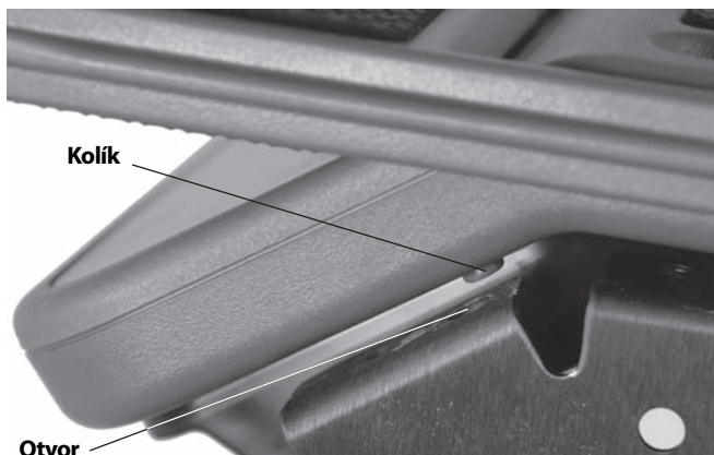
Obrázok č. 14 – Vymedzovací kolík a otvor
