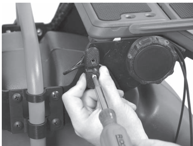
Figura 16 – Montaggio dell'avvolgicavo (notare il cavo USB trattenuto sotto l'avvolgicavo)
