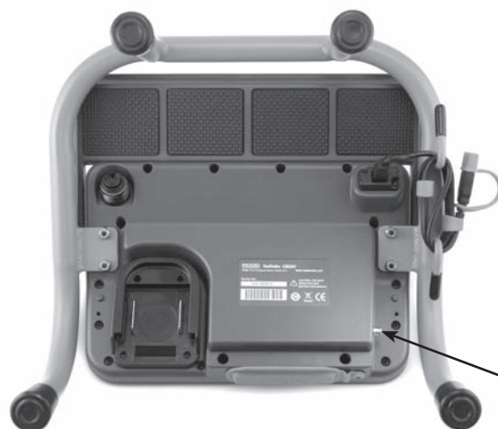
Slika 27 – Priključek za oddajnik na napravi LT1000 Mini
