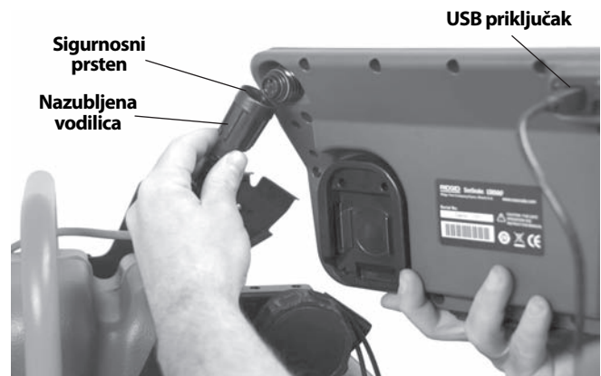
Slika 12 - Spajanje SeeSnake sistemskog kabela
