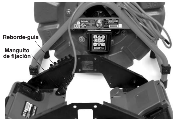
Figura 4 – Conexión del cable del sistema SeeSnake antes de montar el LT1000
