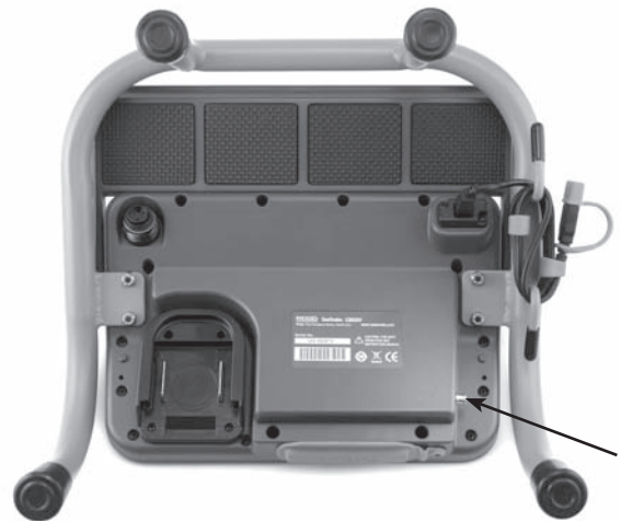
Slika 27 – Priključak sa žabicom LT1000 odašiljača
