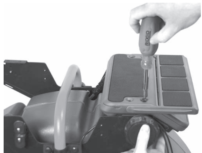
Figura 13 – Montarea platformei din dreapta
