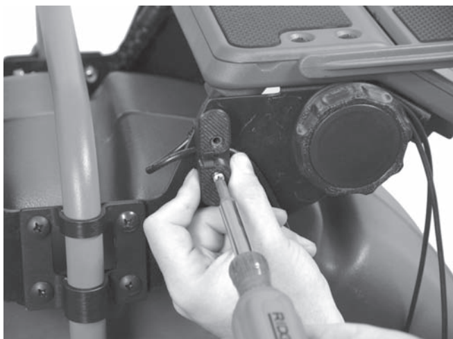
Figur 16 – Montering af kabelvinde (Bemærk: USB-kablet skal være under kabelvinden)
