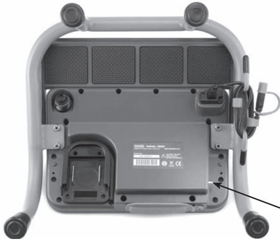
Figura 27 – Terminal de Pinça do Transmissor do LT1000
