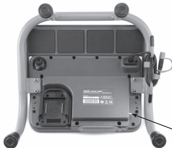
Obrázek 27 – Koncovka pro zapojení vysílače zařízení LT1000
