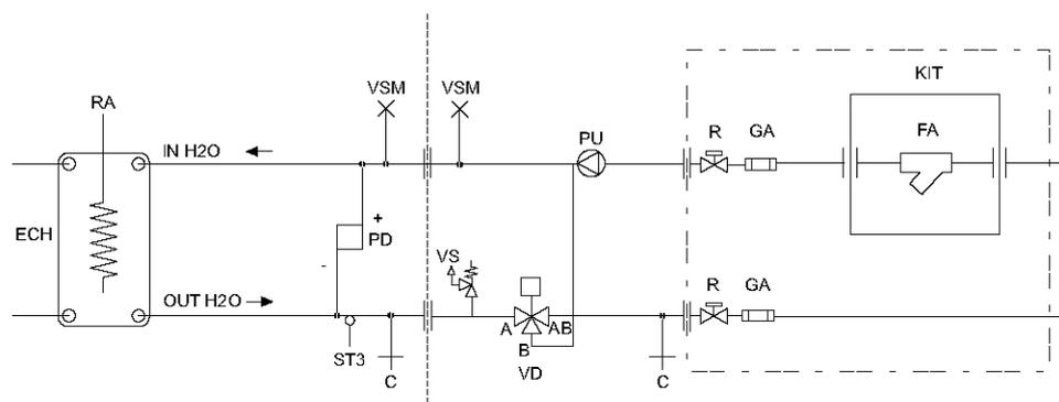
ECH – устройство отвода тепла (конденсатор у ТСHEY, конденсатор/испаритель у ТНHEY)
