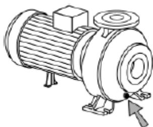
**Проверка насоса (при его наличии):** каждые 5000 часов работы насоса плата управления выдает предупреждение при работающем агрегате. Это означает, что необходимо осмотреть насос. Осмотр заключается во внешней очистке насоса и проверке его общего состояния.
