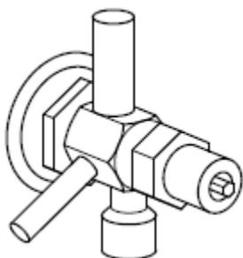
Снимите винтовую крышку сбоку клапана и поверните регулировочный винт отверткой. Увеличивая или уменьшая количество хладагента, можно увеличивать либо уменьшать значение температуры перегрева. Температура и давление в испарителе остается более или менее неизменным независимо от изменения тепловой нагрузки.
