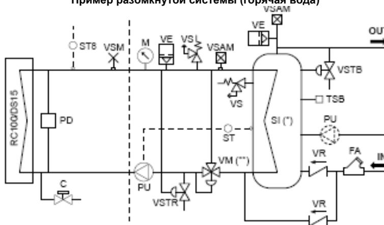
(\*) В случае использования горячей воды в гигиенических целях промежуточный теплообменник (BL) должен монтироваться из соображений гигиены. Из этих же соображений важно не забывать периодически повышать температуру воды в резервуаре в целях проведения дезинфекции от бактерий, в том числе Legionella Pneumophila.
