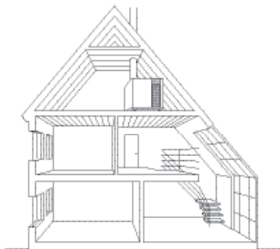
Рис. 15 Установка котла в чердачном помещении
