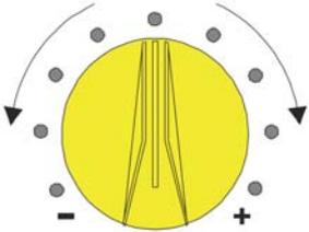
Если регулятор установлен в среднее положение, то действительна номинальная температура в помещении в режиме отопления (стандартная установка 20°C).
