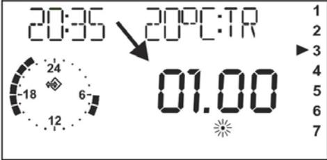
Отображение на дисплее выбранного времени продления режима отопления (в течении 3 сек.)
