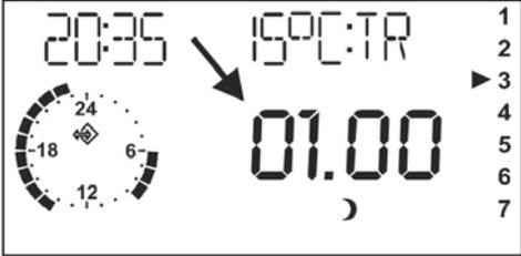
Отображение на дисплее выбранного времени прерывания режима отопления (в течении 3 сек.)
