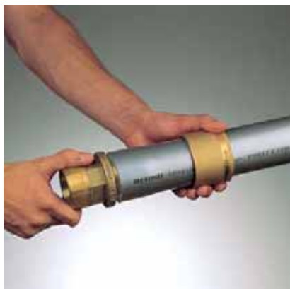
Рис. 50. Вставить фитинг в развальцованную трубу. Через небольшое время труба плотно обожмет фитинг (эффект памяти формы)
