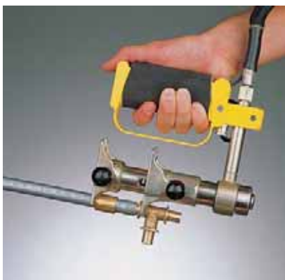
Рис. 43. Вставить соединительное соединение в запрессовочную насадку (тиски) без перекоса
