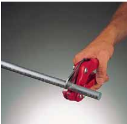
Рис. 37. Отрезать трубу по размеру под прямым углом
