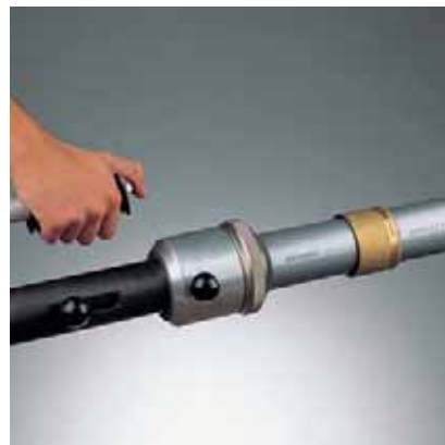
Рис. 49. Произвести развальцовку трубы в два приема, повернув трубу относительно расширительной насадки после первой развальцовки на 30°. Подвижная гильза не должна находиться в зоне развальцовки
