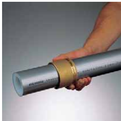
Рис. 48. Надеть на трубу подвижную гильзу фаской в сторону присоединяемого фитинга
