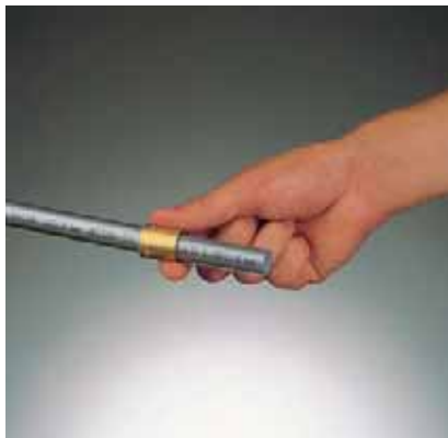
Рис. 38. Надеть на трубу подвижную гильзу фаской в сторону присоединяемого фитинга
