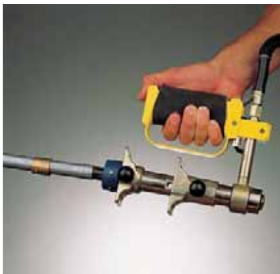
Рис. 40. Расширительный инструмент 16/20. Произвести развальцовку трубы в два приема, повернув трубу относительно расширительной насадки после первой развальцовки на 30°. Подвижная гильза не должна находиться в зоне развальцовки. Трубу и насадку не перекашивать друг относительно друга
