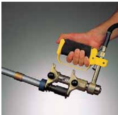
Рис. 41. Расширительный инструмент 25/32. Произвести развальцовку трубы в два приема, повернув трубу относительно расширительной насадки после первой развальцовки на 30°. Подвижная гильза не должна находиться в зоне развальцовки. Трубу и насадку не перекашивать друг относительно друга
