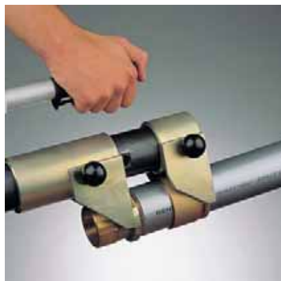
Рис. 51. Вставить соединение в запрессовочную насадку (тиски) без перекаса
