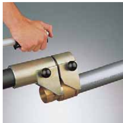
Рис. 52. Привести в действие монтажный инструмент, надвинуть гильзу на соединение.
