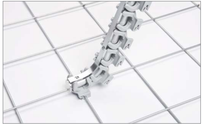
Рис. 3-49 Установить штангу с магазином поворотных клипс
