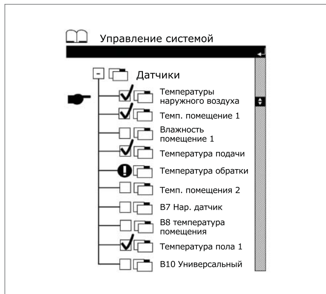
Рис. 7-21 Сервисный уровень – конфигурация датчиков
