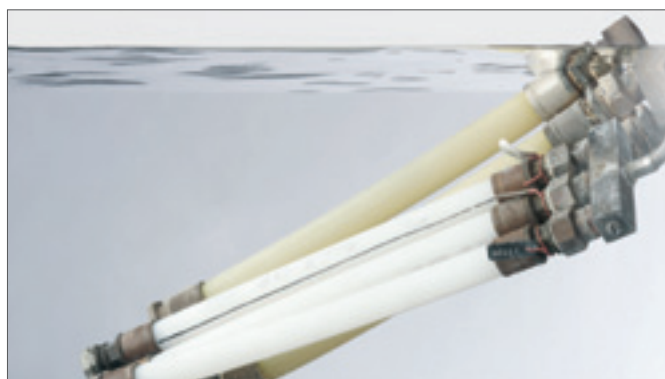
Рис. 4-8 Трубы в момент длительного испытания (под давлением в водном резервуаре)
