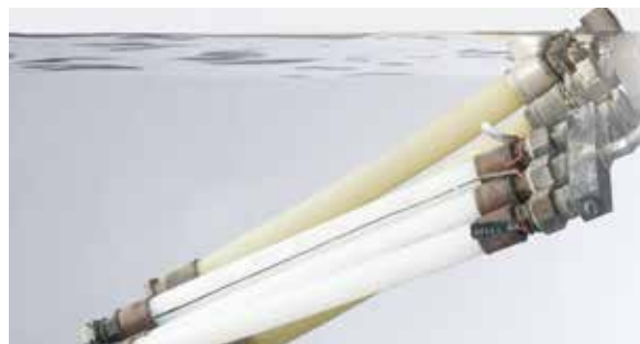
Рис. 4 Трубы в момент длительного испытания (под давлением в водном резервуаре)
