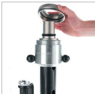
Для замены расширительных насадок снимите крепежную гайку, правильно установите расширительную насадку, затем полностью закрутите крепежную гайку. Для диаметров более 75 мм расширительные насадки навинчиваются напрямую (без крепежной гайки). Расширительные насадки диаметром более 75 мм должны также навинчиваться полностью. Не допускайте возможных перекосов при монтаже.
