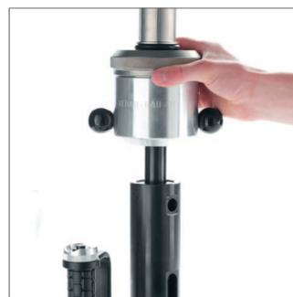
Сначала надвиньте длинную расширительную насадку, а затем короткую. После этого вставьте длинные штифты полностью до упора.
