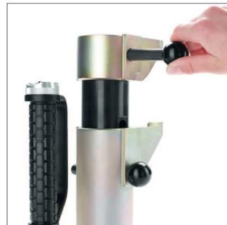
При выполнении монтажа в ограниченном пространстве используйте шестигранный торцевой ключ для освобождения и поворота ручки инструмента.
