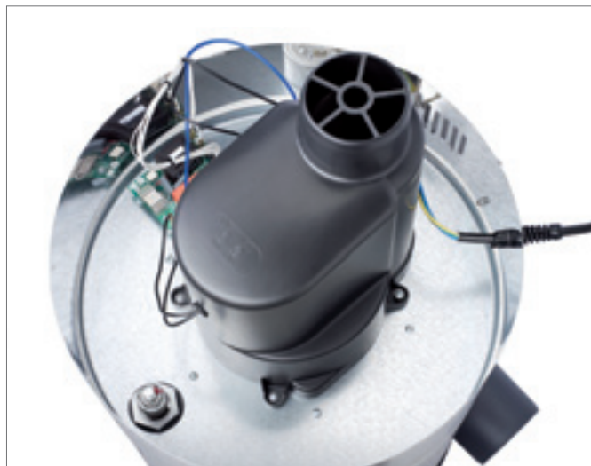
Рис. 8-3 Снять верхний шумозащитный кожух
