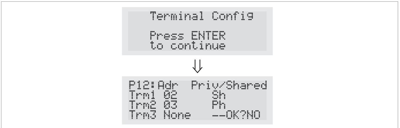
Рис. 17 Назначение перечня частных и совместно используемых терминалов
