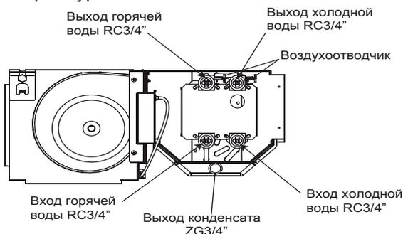
Подключайте холодную воду к соответствующим фитингам 3/4", а горячую к фитингам 1/2". Фитинг входа и выхода воды дополнительно обозначены стрелками.
