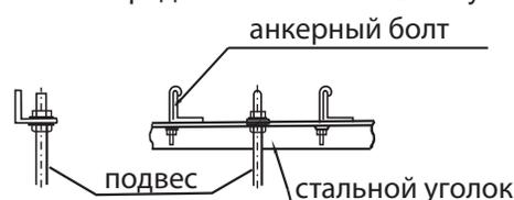
Навесьте вентиляторный доводчик на подвесные болты и закрепите. Выровняйте вентиляторный доводчик в горизонтальной плоскости при помощи уровня, иначе могут быть протечки конденсата.
