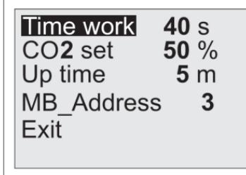
**Time work** – laikas (nuo 0 iki 90 sekundžių), kurį dar veiks agregatas po agregato išjungimo, pulteliu nustačius OFF.
