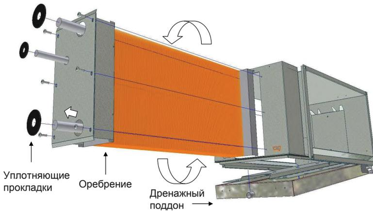
Для того, чтобы оставить сторону подключения охладителя и при этом соблюсти направление движения воздуха, указанное стрелкой на корпусе теплообменника, можно перевернуть сам теплообменник на 180° вокруг своей оси как показано на рис. 10. При этом, для облегчения проводимых действий, переверните охладитель поддоном вверх.
