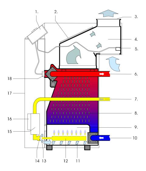
Рис.1 - Рабочая схема котла
