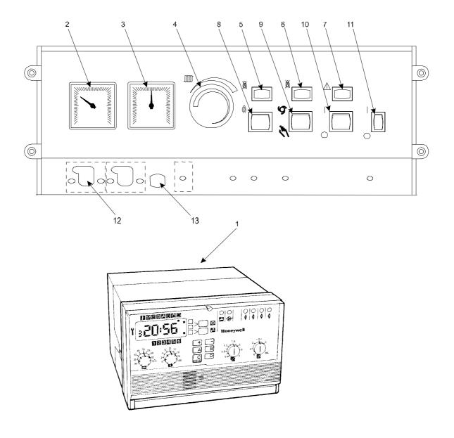
Рис.3 б - Панель управления и сервисные элементы 80 KLR
