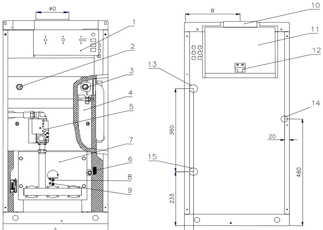
1 - панель управления; 2 - штуцер подключения датчика давления ОВ; 3 - штуцер подключения датчика температуры ОВ; 4 - чугунный теплообменник 5 - газовый клапан (комбинированная газовая арматура); 6 - штуцер для залива и слива воды; 7- фланец горелки; 8 - ионизационный электрод; 9 - электроды розжига; 10 - дымовой патрубок; 11 - тягопрерыватель; 12- датчик тяги (аварийный термостат продуктов сгорания) 13 - штуцер выхода ОВ; 14 - подача газа; 15 - штуцер входа ОВ.
