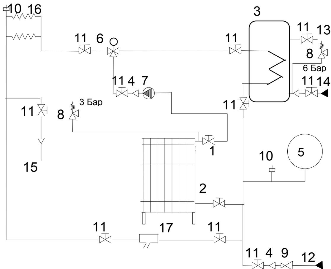
1 - выход воды; 2 - обратная вода; 3 – внешний бойлер; 4 - обратный клапан; 5 - закрытый компенсатор объема; 6 - трехходовой клапан с электроприводом; 7 - циркуляционный насос системы отопления; 8 - предохранительный клапан; 9 - редукционный клапан; 10 – автоматический воздухоотводчик; 11 – шаровой кран; 12 - заполнение химочищенной водой; 13 – отбор воды на ГВС; 14 – подача водопроводной воды; 15 - слив воды; 16 - радиаторы отопления; 17 – фильтр-грязевик.
