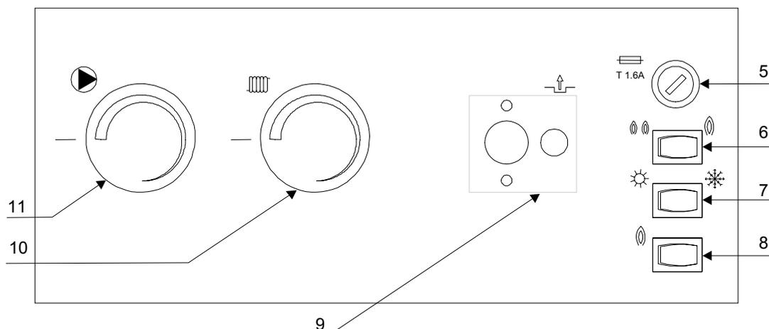
5 - сетевой предохранитель; 6 - переключатель полной мощности  $\text{---}$  и сниженной мощности  $\text{---}$  (у котла 60KLO отсутствует); 7 - переключатель ЛЕТО – ЗИМА; 8 – кнопка RESET; 9 – аварийный датчик температуры (термостат); 10 -терморегулятор отопления; 11 – терморегулятор насоса
