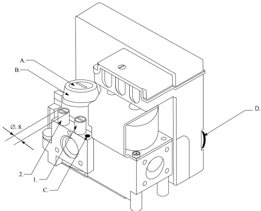
1 – штуцер измерения давления газа на входе в арматуру; 2 – штуцер измерения давления газа на выходе из арматуры; А – защитная крышка; В – регулировочный винт максимума; С – регулировочный винт минимума; D – потенциометр настройки минимума
