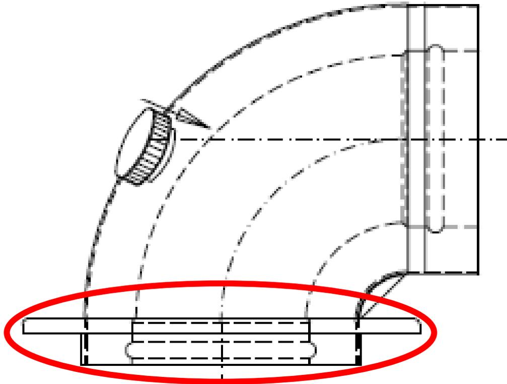
**Фланец приспособлен так, что бы было возможно соединить эту деталь с выходом вентилятора, который находится заподлицо с верхним покрытием котла.**
