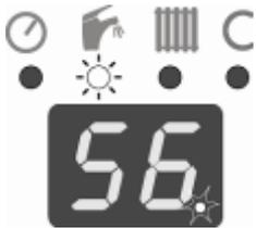
Все способы отображения температуры воды отопления и давления воды отопления аналогичны способам отображения у комбинированных версий котлов серии "Panther". Исключением является отсутствие отображения температуры горячей хозяйственной воды в накопительном баке, если не подключён датчик.
