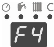
Автодиагностика системных котлов серии "Panther" аналогична автодиагностике комбинированных версий, за исключением возможности отображения сообщения о неисправности F4.
