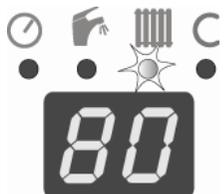
Нажимайте кнопку "MODE" до тех пор, пока у символа **"радиатор"** не начнёт мигать светодиод. С помощью кнопки (+) или (-) установите требуемое значение температуры воды отопления. Диапазон настройки: --, 45, 50, 55, 60, 65, 70, 75, 80, 85°С. Для отключения нагрева (режим "LETO") введите параметр (--).
