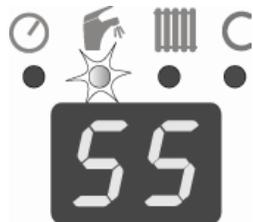
Способ настройки параметров воды отопления аналогичен настройке у комбинированных версий котлов серии "Panther". Однако исключением является невозможность настройки функции "**KOMFORT**" и температуры горячей хозяйственной воды в накопительном баке, если не подключён датчик горячей хозяйственной воды.
