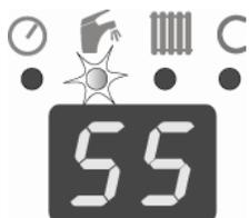
Нажимайте кнопку "MODE" до тех пор, пока у символа **"кран"** не начнёт мигать светодиод. С помощью кнопки (+) или (-) установите требуемое значение температуры горячей хозяйственной воды. Диапазон настройки: --, 40, 42, 45, 48, 50, 52, 55, 58, 60 °С. Чтобы отключить нагрев горячей хозяйственной воды, введите параметр (--).
