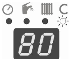
Использование этой функции позволяет добиться ещё более быстрой подачи горячей хозяйственной воды. В этом режиме котёл периодически нагревает теплообменник горячей хозяйственной воды приблизительно до температуры, которая была задана пользователем в режиме настройки температуры горячей хозяйственной воды.
