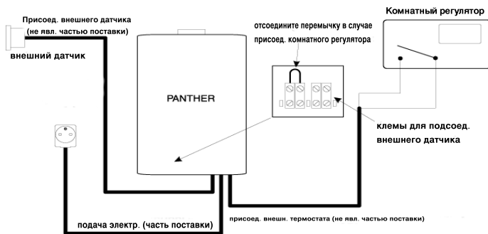
Рис. 14 – Эл.подсоединение термостата и внешнего датчика
