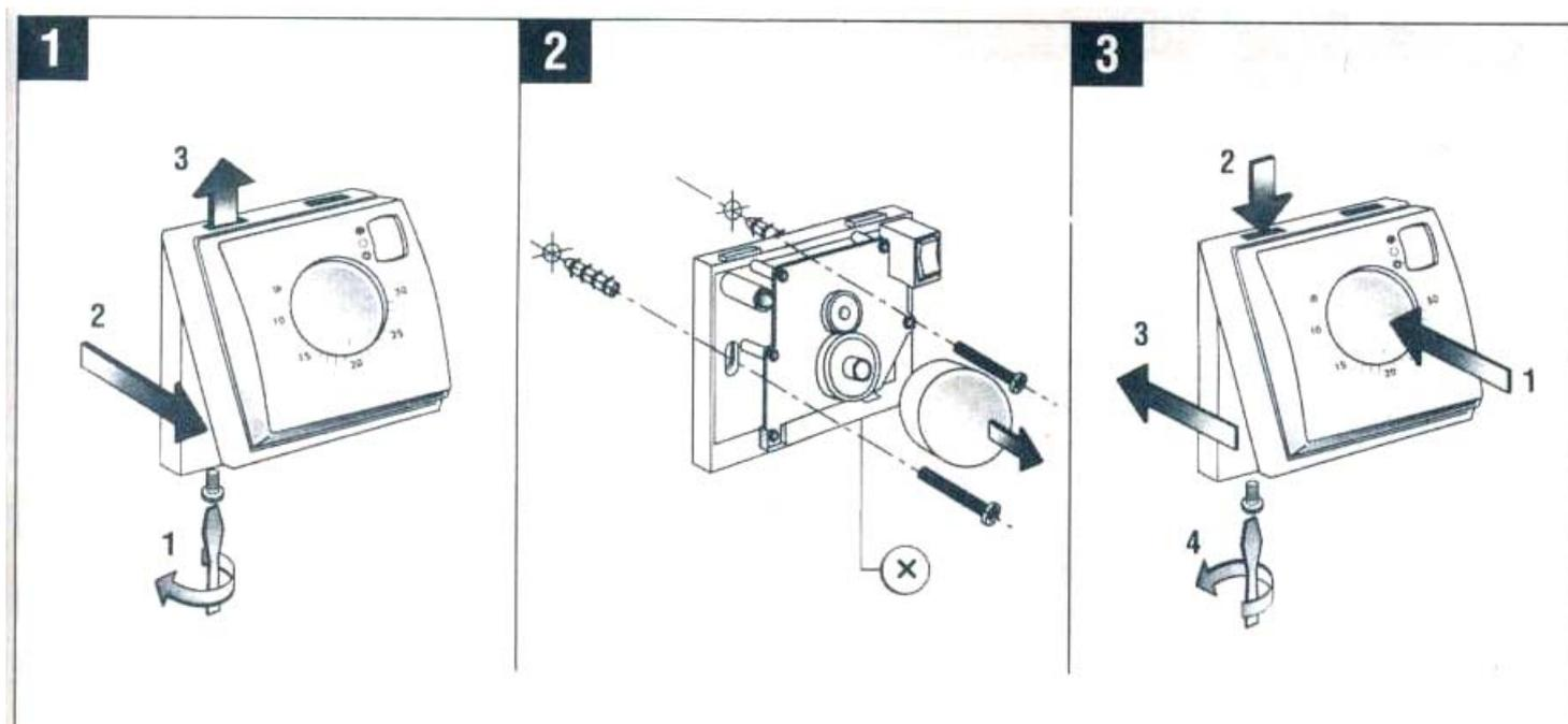
**1.** Открыт котобку регулятора при помощи отвертки (1). Винт некрутить полностью, только ослабить, что бы было возможно снять пререднюю часть в перед (2) и вверх (3)
