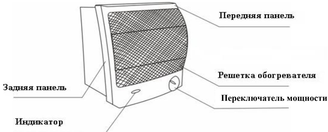
Задня панель, Індикатор, Передня панель, Решітка обігрівача, перемикач потужності
