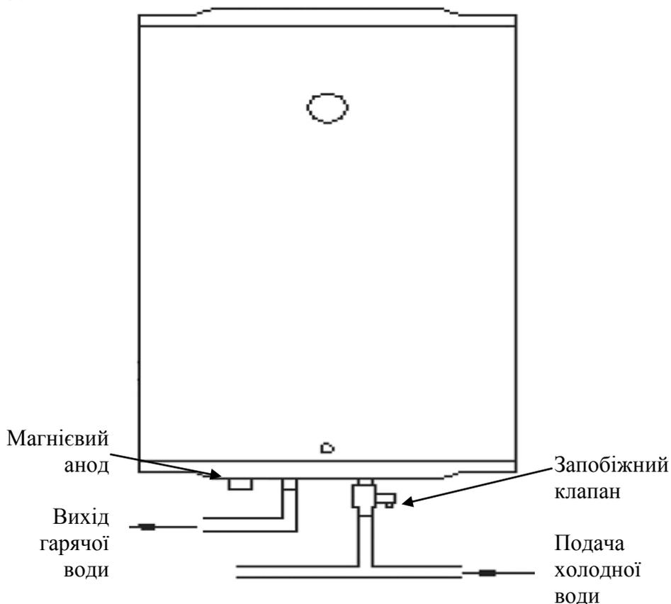
Щоб уникнути поломок при закручуванні запобіжного клапана не застосовуйте великих зусиль.
