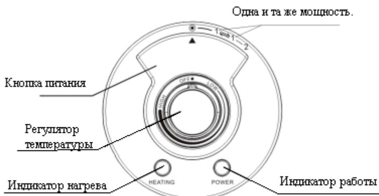
1. С помощью переключателя мощности установите необходимую мощность (1300Вт /2000Вт). От выбора мощности зависит скорость (время) нагрева воды до заданной температуры. При включении переключателя мощности в позицию «1» прибор работает с мощностью 1300Вт. При включении переключателя мощности в позицию «2», прибор работает с мощностью 2000Вт. Горящая индикаторная лампочка обозначает нагрев воды.
