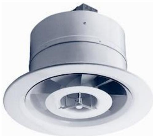
Круглые вихревые диффузоры DZA предназначены для подачи воздуха системами вентиляции и кондиционирования в помещениях общественного и производственного назначения больших объемов и / или с высокими потолками (концертные, спортивные, выставочные залы, стадионы, торговые комплексы, производственные цеха, вокзалы, ангары и т.п.) закрученными струями из верхней зоны помещений. Их можно использовать для формирования горизонтальных, вертикальных или смешанных воздушных струй.
