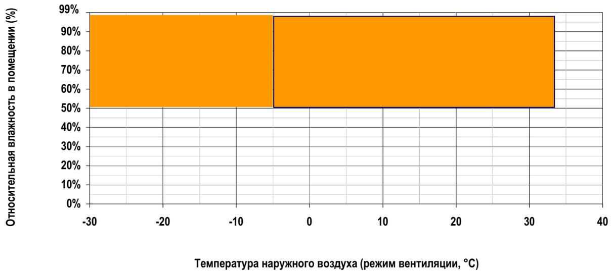
Установки PS должны эксплуатироваться температуре в помещении бассейна от 10°C до 36°C, относительной влажности в помещении от 50% до 99%; температуре наружного воздуха (режим вентиляции) от -30°C до to 36°C.
