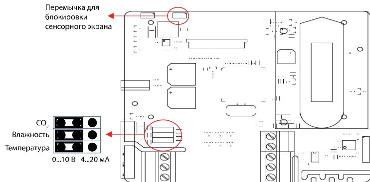
Установите перемычку блокировки сенсорного экрана при использовании преобразователя в общественных местах, при этом использование меню настройки будет отключено.
