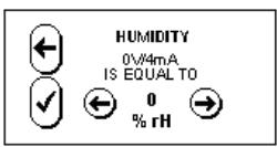
В меню «LOW LIMIT» возможно установить значение влажности «HUMIDITY», при котором выходной сигнал будет равен 0 В (или 4 мА). Заводская настройка 0 В (или 4 мА) при 0%.
