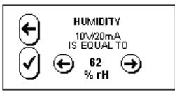
В меню «HIGH LIMIT» возможно установить значение влажности «HUMIDITY», при котором выходной сигнал будет равен 10 В (или 20 мА). В данном примере выходной сигнал будет равен 10 В при 62% влажности, заводская настройка 10 В (или 20 мА) при 100%.
