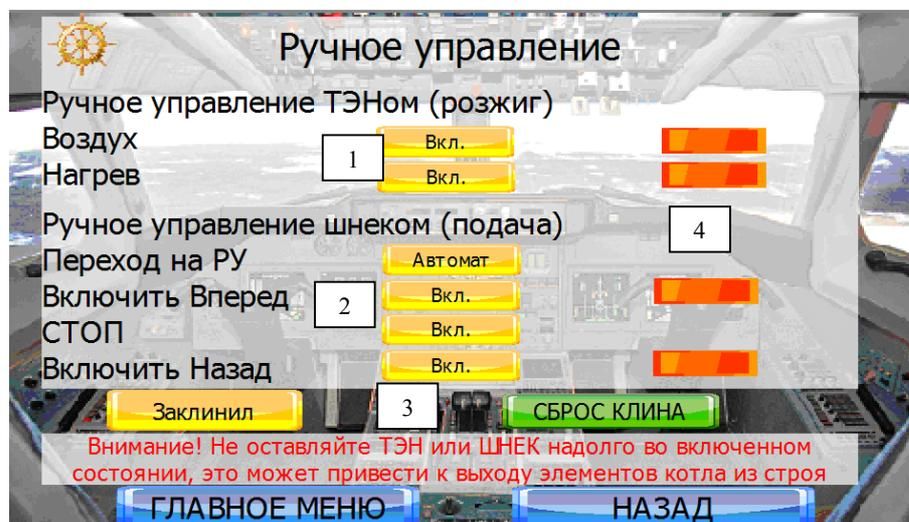
Экран "РУЧНОЕ УПРАВЛЕНИЕ" позволяет вручную запускать фен, а так же управлять вращением шнека.
