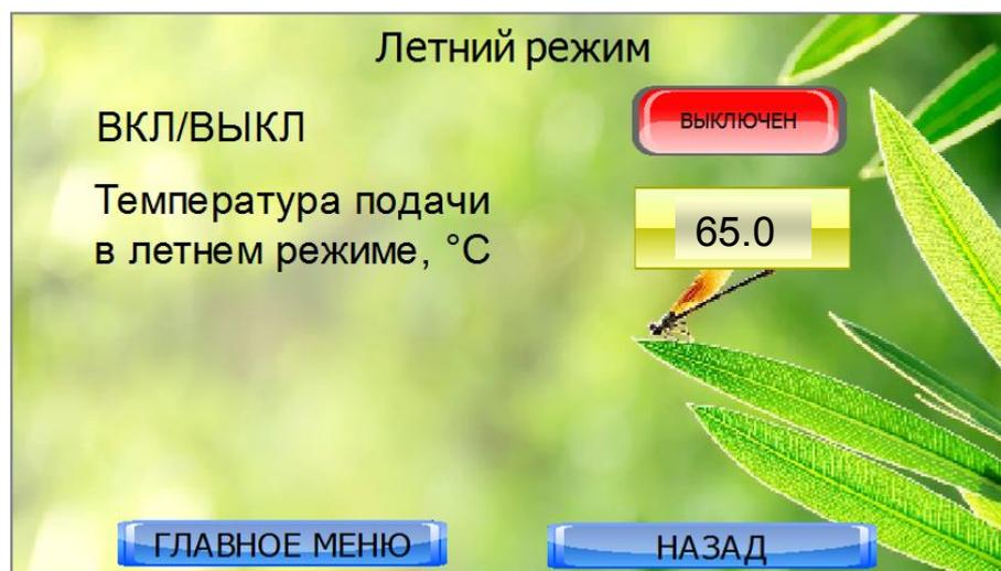
Кнопка ВКЛ/ВЫКЛ - то же, что кнопка ЛЕТНИЙ РЕЖИМ на экране РЕЖИМ РАБОТЫ НАСОСОВ. При включении летнего режима здесь необходимо выключить остальные режимы во вкладке насосы.
