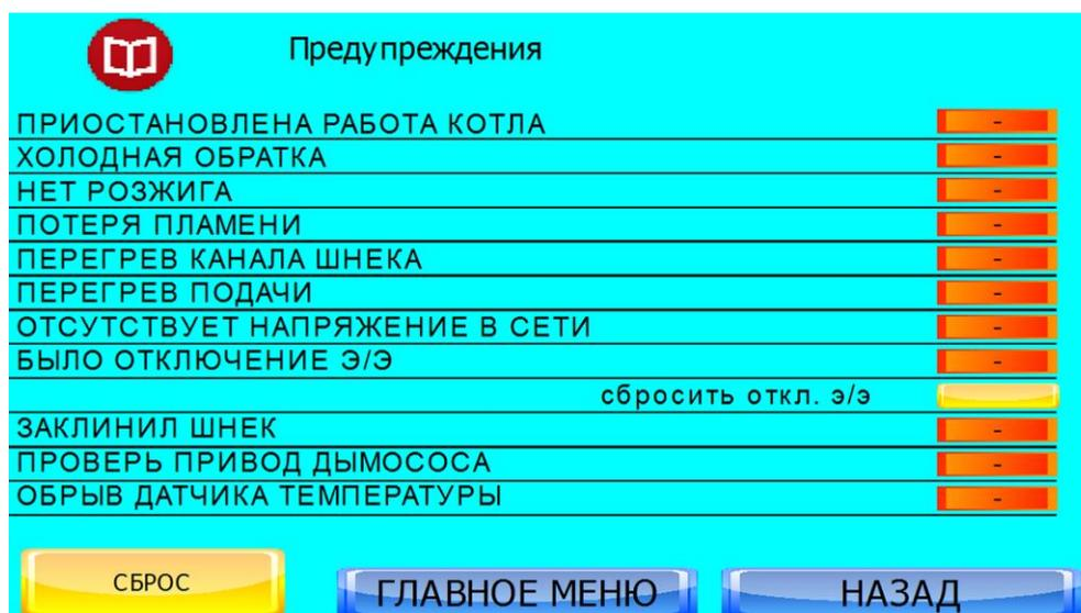
Экран ПРЕДУПРЕЖДЕНИЯ энергонезависим и сохраняет значения после отключения питания. Перед тем как сбросить предупреждение устраните его причину. Индикаторы загораются зеленым при наличии предупреждения, при отсутствии предупреждения индикаторы красные.
