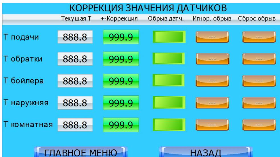
Экран предназначен для контроля за работой датчиков температуры.
