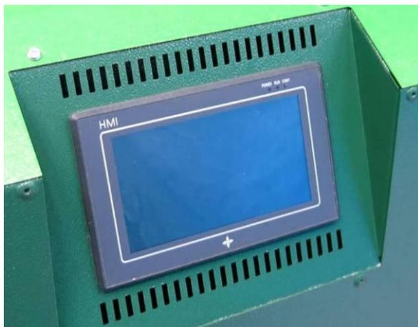
Контроллер имеет систему энергосбережения. После 30 минут бездействия экрана (отсутствия касаний) экран перейдет в спящий режим. Для перехода в активный режим необходимо коснуться экрана.
