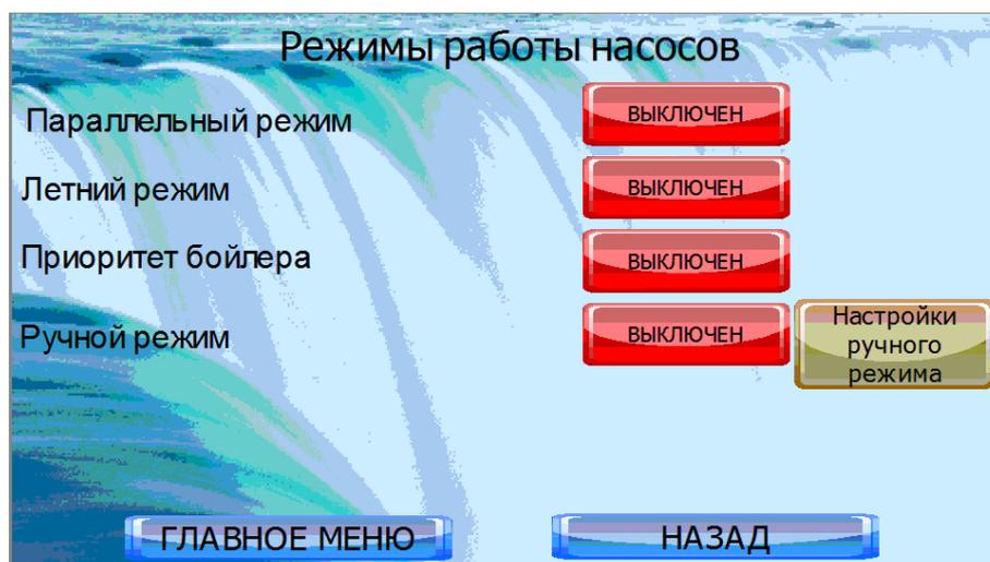
Можно выбрать между четырьмя режимами работы насосов. Не следует включать несколько режимов одновременно или отключать все режимы.
