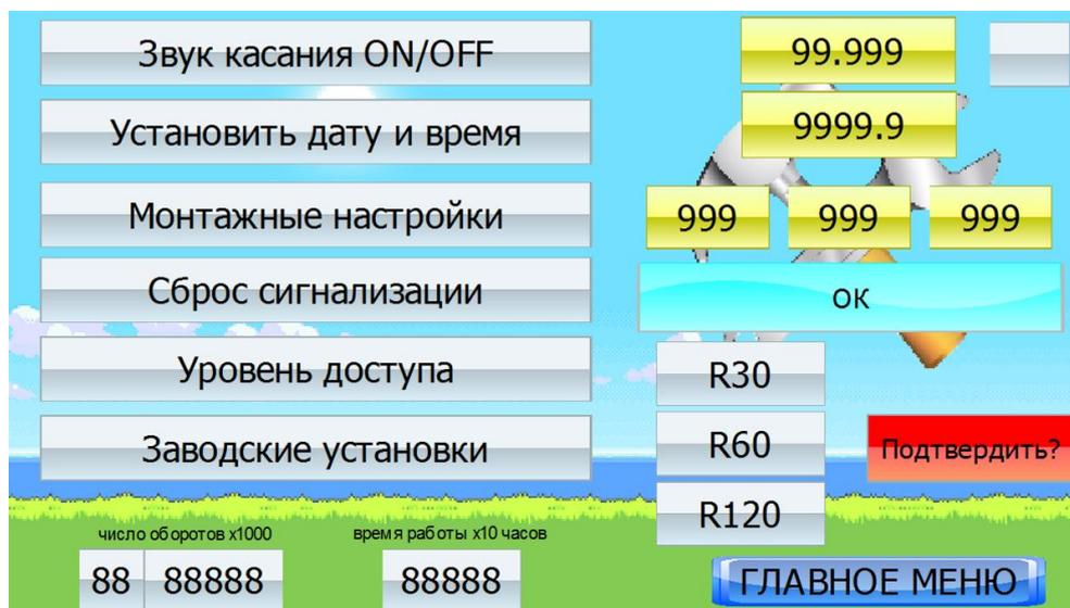
Кнопка **ЗВУК КАСАНИЯ** позволяет включить или выключить звук при нажатии на экран.
