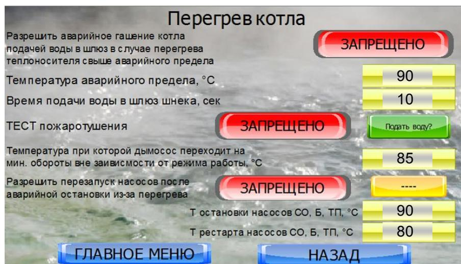
Перегрев котла (достижение температуры аварийного предела) - ситуация, которая может потребовать таких действий, как водяное пожаротушение, принудительный переход котла в режим противодействия обратной тяге (минимальные обороты дымососа) и остановку насосов для исключения подачи перегретой воды в систему отопления.
