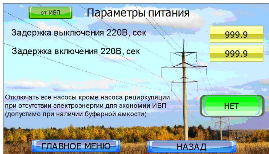
Показатель **ЗАДЕРЖКА ВЫКЛЮЧЕНИЯ 220В** - позволяет задать время задержки начала выключения котла при отключении сетевого питания. Следует сопоставлять это время с емкостью ИБП и устанавливать значение показателя с большим резервом емкости.
