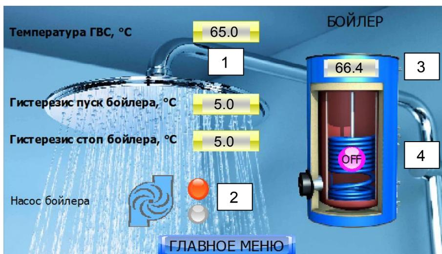
Показатель ТЕМПЕРАТУРА ГВС - позволяет задать температуру бойлера, равна температуре бойлера на экране СИСТЕМА ОТОПЛЕНИЯ.
