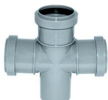
Расположите крестовину как показано на рисунке выше. Вставьте переходники слева и справа до упора (рекомендуется предварительно смочить резиновые прокладки крестовины водой). Вставьте заглушку снизу до упора. Вставьте двухметровую трубу в крестовину сверху (верх трубы остается открытым). Сборка ограничителя завершена.
