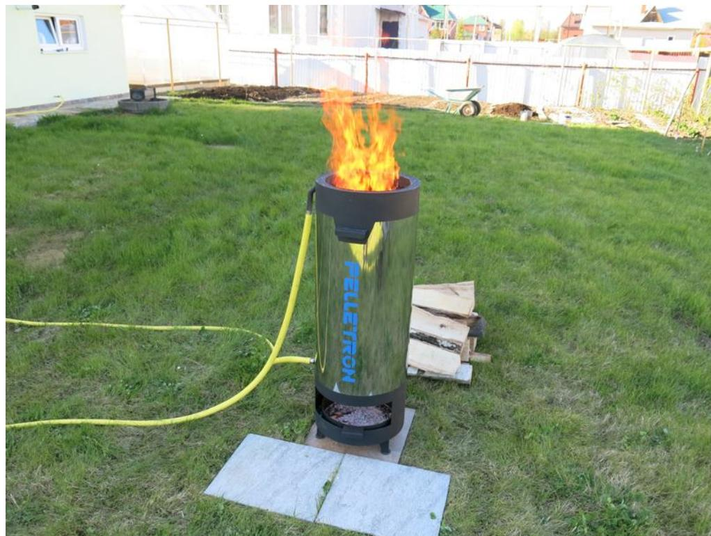
**ЗАПРЕЩАЕТСЯ** оставлять работающий нагреватель без присмотра! Следите за работой нагревателя и стабильностью протока воды, не допускайте перегрева и кипения нагревателя.
