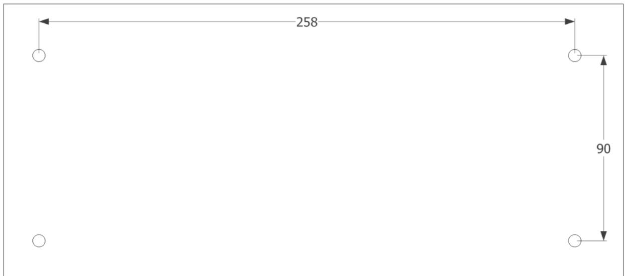
Рис. 2 - Схема крепежных отверстий БУ ТЭН
