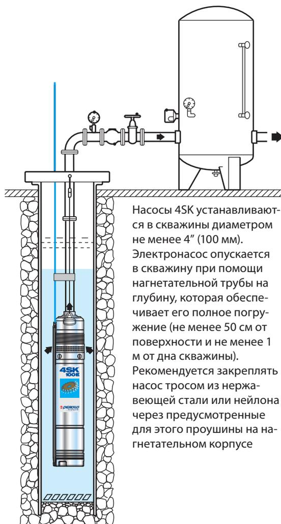
Насосы 4SK устанавливаются в скважины диаметром не менее 4" (100 мм). Электронасос опускается в скважину при помощи нагнетательной трубы на глубину, которая обеспечивает его полное погружение (не менее 50 см от поверхности и не менее 1 м от дна скважины). Рекомендуется закреплять насос тросом из нержавеющей стали или нейлона через предусмотренные для этого проушины на нагнетательном корпусе
