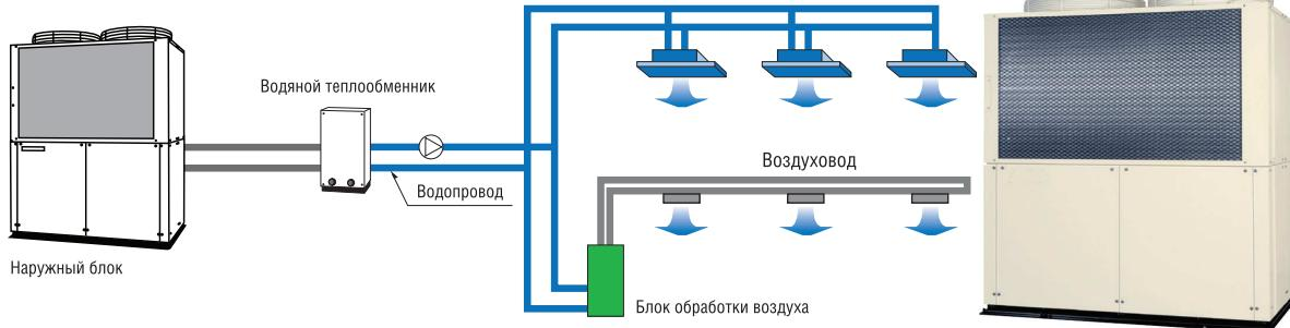
Водяной теплообменник **Panasonic** может обеспечивать потребности в воде в широком диапазоне температур для различных производственных нужд – от создания комфортных условий проживания и кондиционирования до приготовления пищи, а также может служить заменой стандартных бойлеров и других систем.
