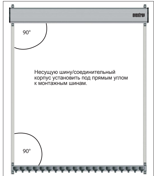
Рис. 17: Коллектор (рис. ОКР 20) без вакуумированных труб.
