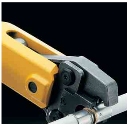
Труба „Coripe“ с прессовым соединением
