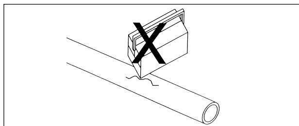
Защищать трубу от механических повреждений и деформаций.
