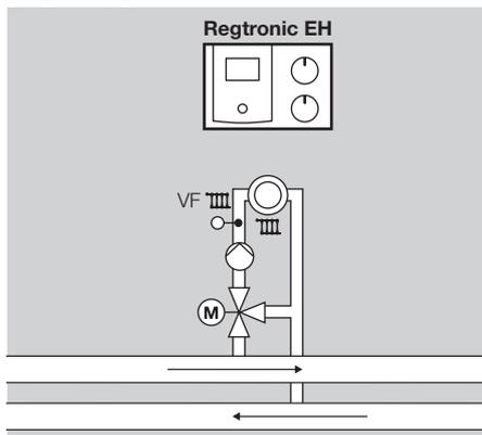
Такая функция активируется автоматически при подключении датчика линии прямой подачи (VF/VFAS).
