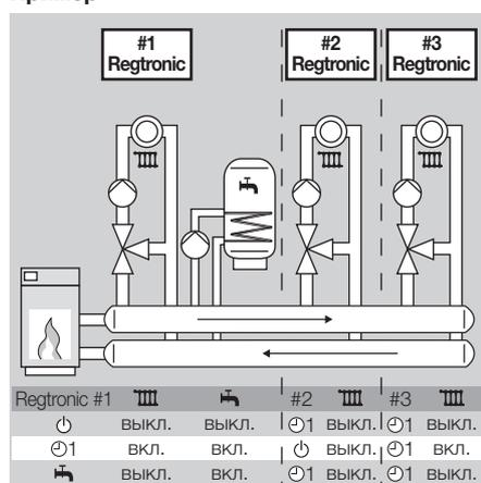
Система с тремя смешанными отопительными контурами и подготовкой горячей воды: Regtronic № 1 производит регулировку первого отопительного контура и температуры горячей воды. Regtronic № 2 производит регулировку второго отопительного контура, а Regtronic № 3 третьего. При выборе для Regtronic № 1 режима ☺ вся система выключается, независимо от настройки другого регулятора.
