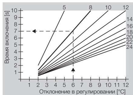
При отклонении регулятора в 6 °C производится регулировка смесителя в теч. 7 с, и он остается открытым 3 с.
