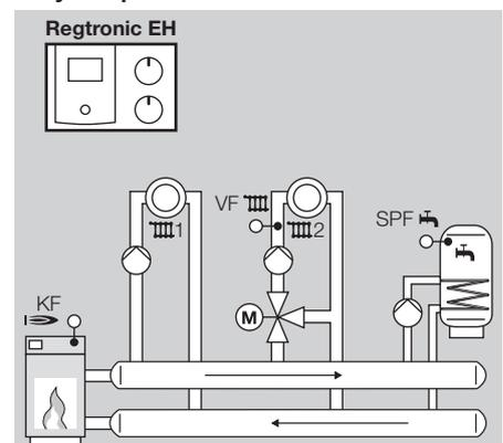
Подключить датчик теплогенератора (KF/KFS), датчик линии подачи (VF/VFAS) и датчик емкостного водонагревателя (SPF/SPFS), Параметр 38 = „----“ (нет адреса нагревательного модуля)
