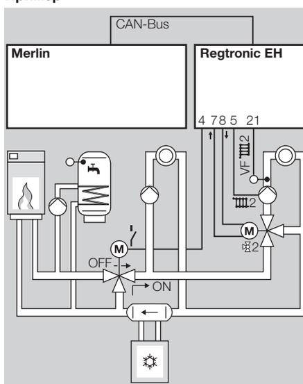
Центральный регулятор включает режим охлаждения через шину CAN и управляет работой теплогенератора, холодильной машины, процессом подготовки горячей воды и прямым отопительным контуром. Устройство Regtronic EH управляет байпасным клапаном и смешанным отопительным контуром.
