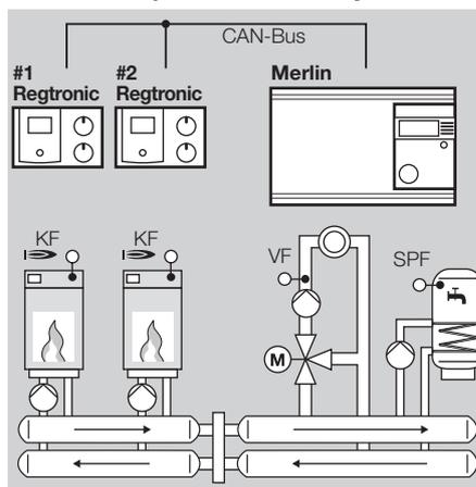
Работа начинается автоматически, как только будет подключен датчик теплогенератора (KF/KFS) и настроен параметр 38 = 1–8 (адрес нагревательного модуля).
