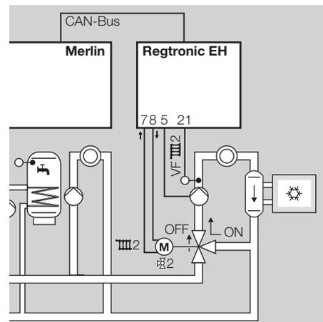
Смеситель в отопительном контуре работает как клапан. Смеситель открывается (ON). Насос отопительного контура включен.
