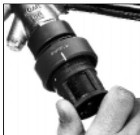
Рис. 13: Снять маховик. Держатель чувствительного элемента вернуть в штатив, вращая вправо, до упора, затем повернуть налево, так чтобы юстировочная отметка была напротив указателя настройки. (ср. рис. 2.)
