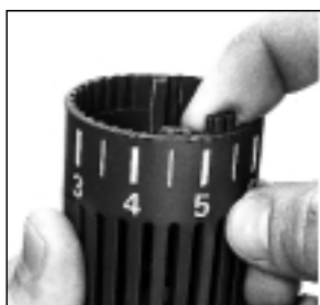
Рис. 10: Две клипсы, находящиеся внутри маховика, вынуть согласно указаниям к рис. 5 и вставить в пазы до и после цифры „5”. (Паз напротив цифры „5” остается свободным.)
