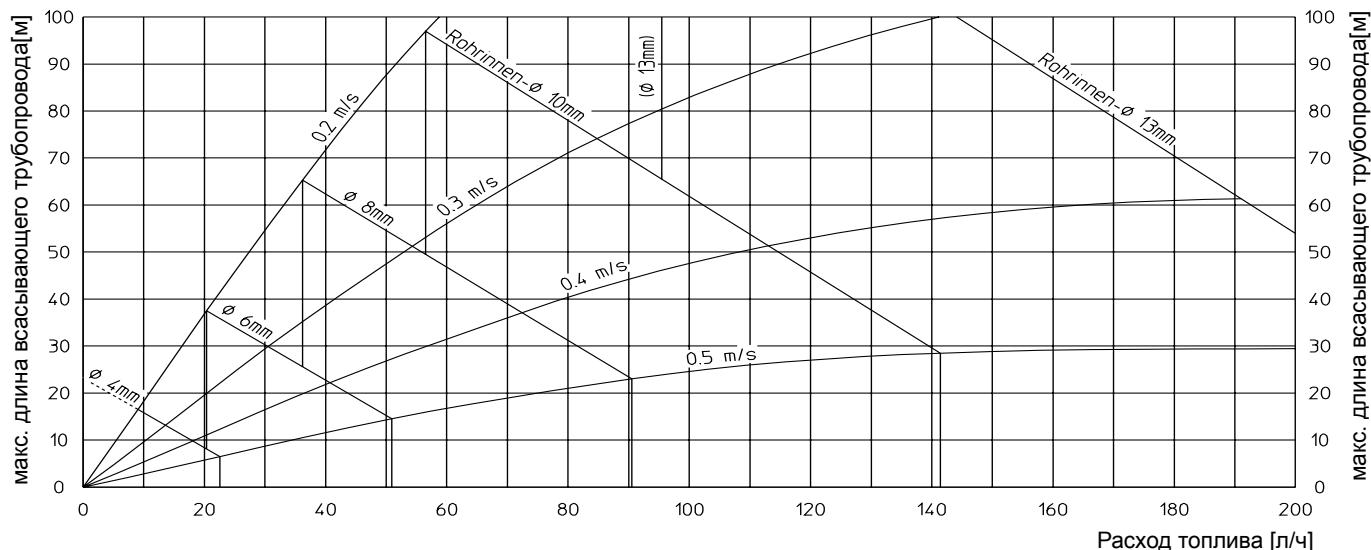
Эти значения действительны для трубопровода без изгибов, сопротивления установленной арматуры в примере монтажа учтены (мембранный предохранительный клапан и фильтр/„Toc-Duo“). При максимальной длине всасывающего трубопровода насос горелки должен подавать давление ок. 0,4 бар.
