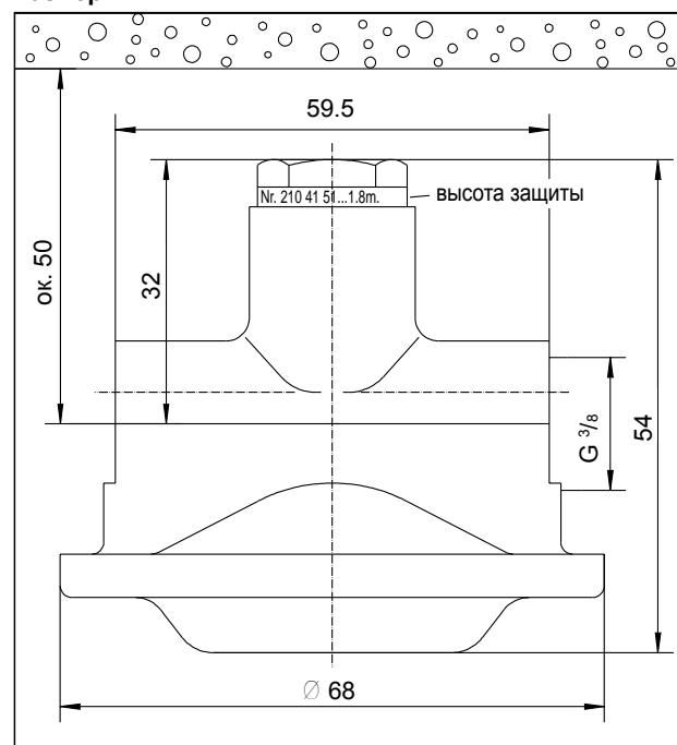
в области от 1 до 4 м , рекомендуется применять плавно настраиваемый мембранный предохранительный клапан арт. № 2104103.
