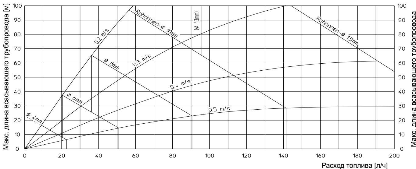
Эти значения действительны для трубопровода без изгибов, сопротивления установленной арматуры в примере монтажа учтены (мембранный предохранительный клапан и фильтр „Toc-Duo“). При максимальной длине всасывающего трубопровода насос горелки должен подавать давление ок. 0,4 бар. Изгибы трубы, запорные и переключающие вентили и
