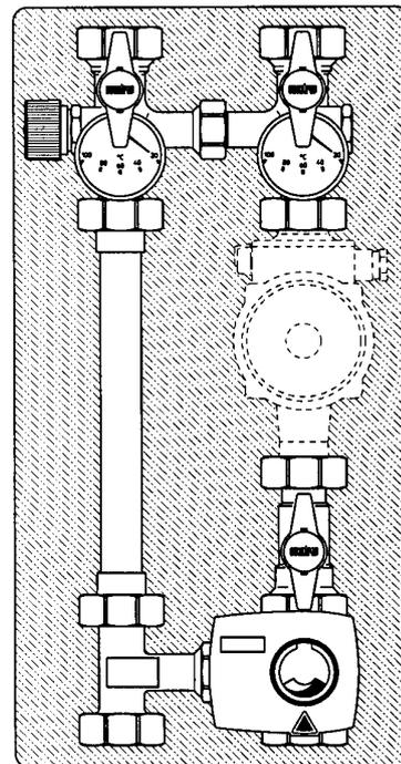
\* Наклон маховика на обратном клапане перед насосом обеспечивает принудительную циркуляцию.
