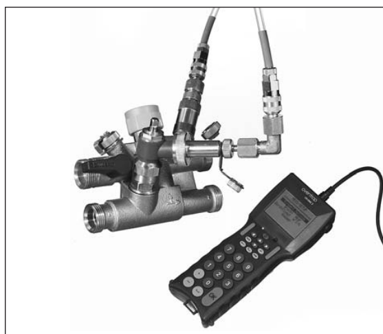
Рис. 6 Измерение перепада давления вторичного контура
