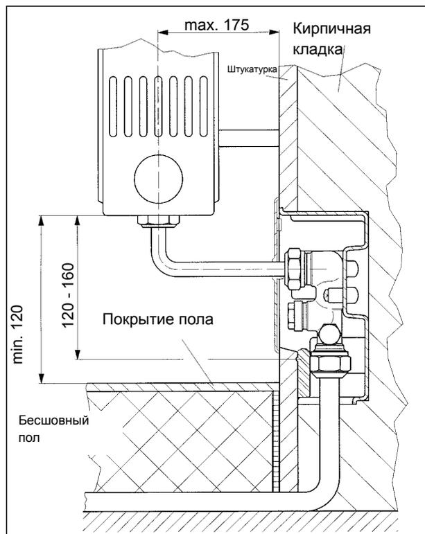
Двухтрубный режим (байпасный винт закрыт)
