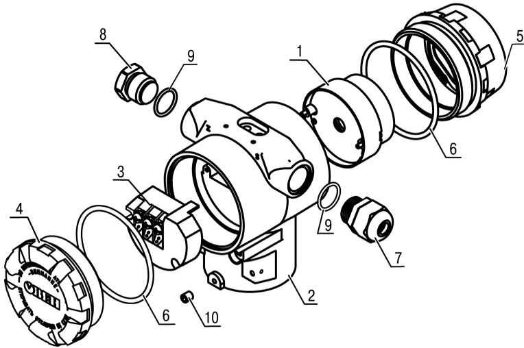
**Рисунок 3.2 – Конструкция преобразователя**
