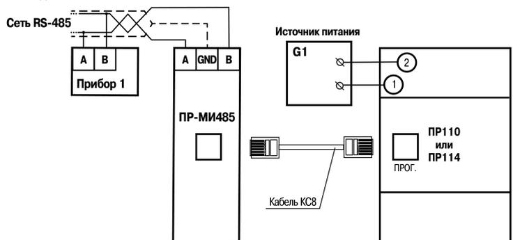
Рисунок 2 – Схема подключения прибора к ПР11х
