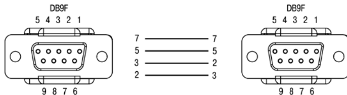
Рисунок В.6 – Кабель KC4 для подключения ПЛК100 к панелям ИП320, СП270 и СП3хх (порт RS-232 Download)
