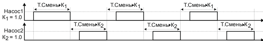
Рисунок 3.5 - Работа насосов при одинаковых коэффициентах хода
