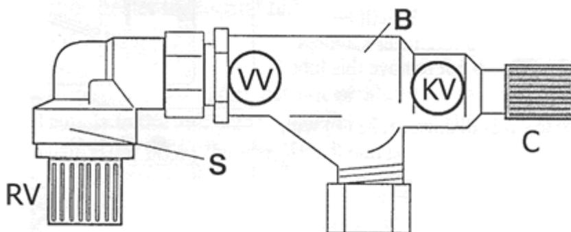
**Предохранительный клапан (S)** При нагревании воды из клапана может капать вода, если давление внутри бака превышает 9 бар. Установлен либо на смесительном кране, либо в нижней части водонагревателя.
