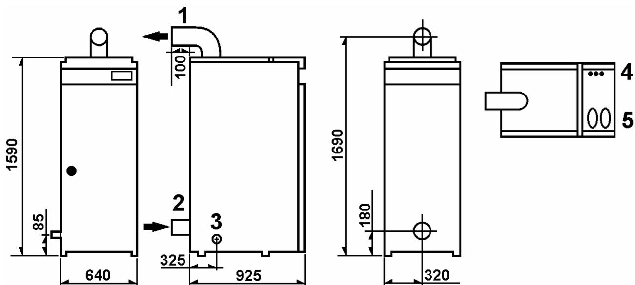
1. Подающий поток  $\varnothing$  100 мм (сварка)
